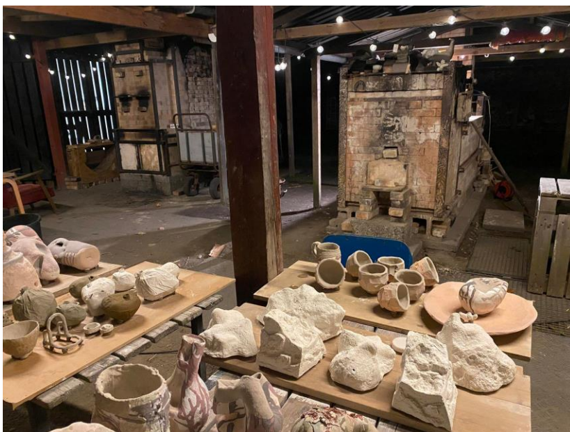
Bilde 22- Keramikken ble sortert etter høyde. Bourrybox ovnen sees til høyre i bildet. Eget foto
