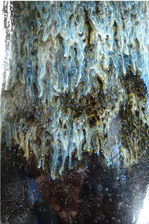
Bilde 33-Eksempel på harefur effekt med jernholdig glasur og askeglasur, vedbrent. Hentet fra https://ceramicartsnetwork.org/ceramic-recipes/recipe/Oil-Spot-and-Hares-Fur-Glazes#
