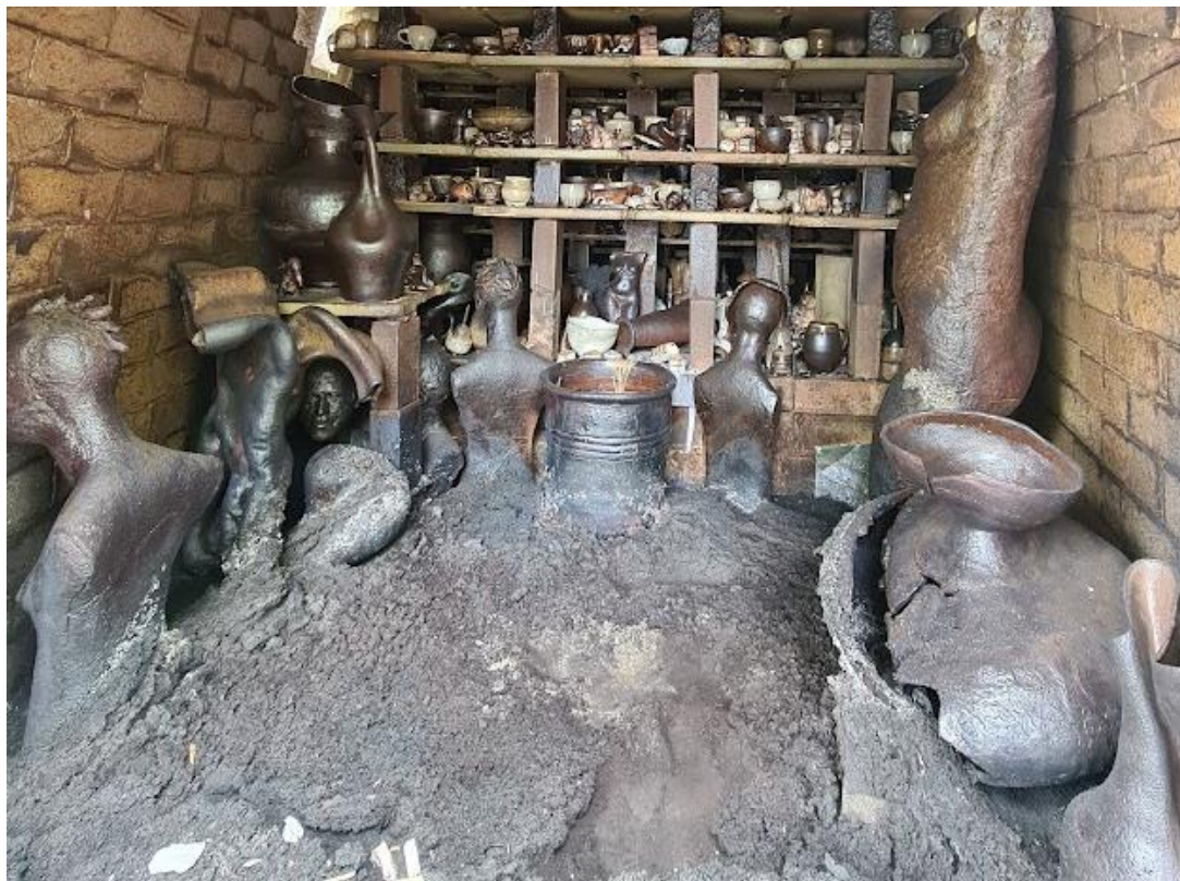
Bilde 36-fyringskammeret før asken ble tatt ut. Tydelig kollaps og sprekker i krukken min som vises på høyre side i bildet. Eget foto
