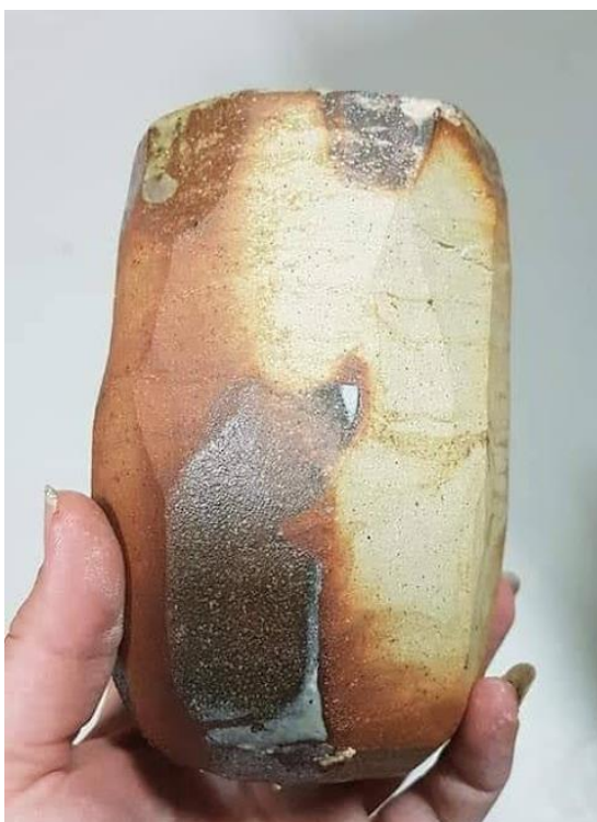
Bilde 28- Eksempel brukt i diskusjon om flammens påvirkning på keramikken. Det tydelig lyse området er skygge der flammer og aske ikke har nådd.
