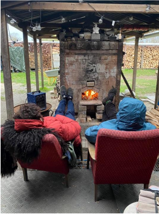
Bilde 24- To fyrer Bourrybox trainkiln. Eget foto
