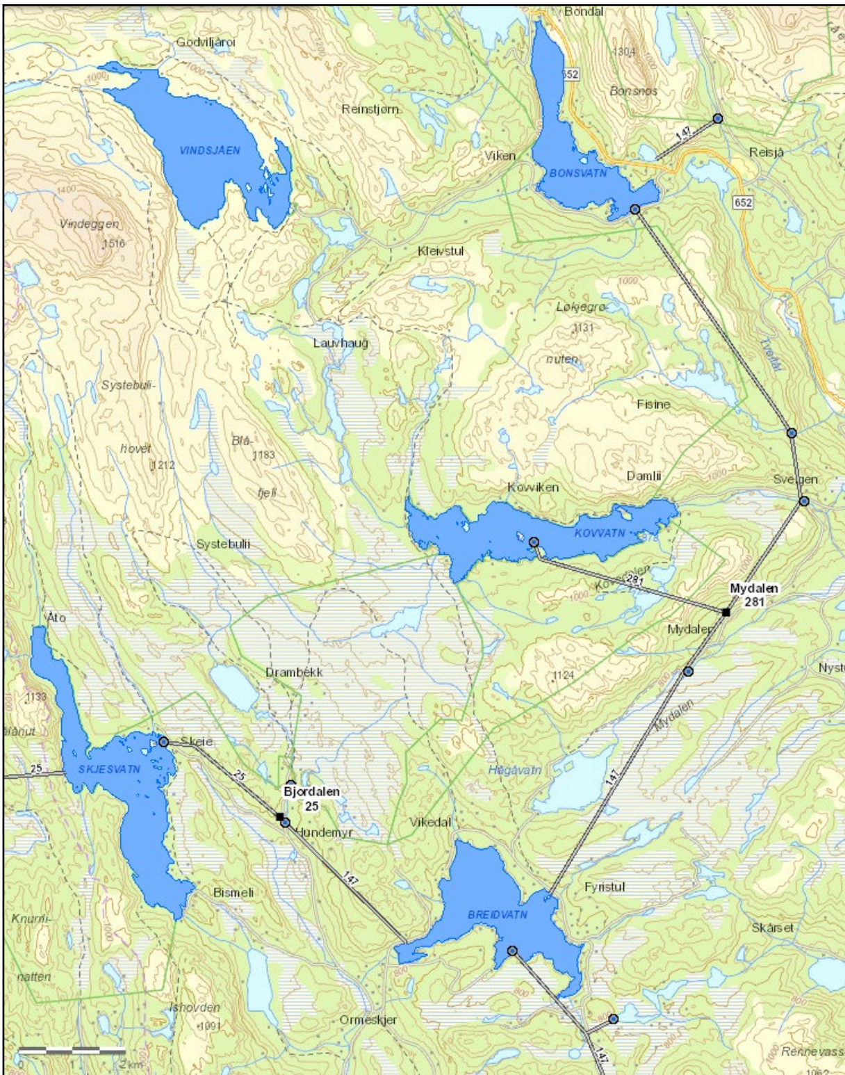
Figur 1. Oversiktskart over reguleringsområdet og overføringer for Hjørdøla kraftverk med Vindsjøen, Kova og Kova-nettet. Reguleringsmagasiner er markert i mørkeblått. Kova tappes i det naturlige elveleiet fra Vindsjøen til Kova-nettet. Fra NVE Atlas ( https://atlas.nve.no/html5Viewer/?viewer=nveatlas ).
