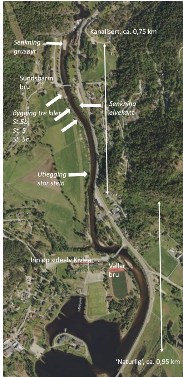
Figur 3. Den undersøkte elvestrekningen av Vallaråi (med innløp Kivleåi) som viser plassering av alle habitattiltak som ble gjennomført mellom 2012 og 2013. Alle tiltakene ble utført i den øvre kanaliserte delen av elva.
