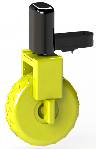
Figur 29: Armmodul med hjulmodul uthevet i gult
