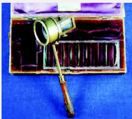
Helmholtz oftalmoskop fra 1851. (Bildet er gjengitt med tillatelse fra The Moorfields Collection, London).
