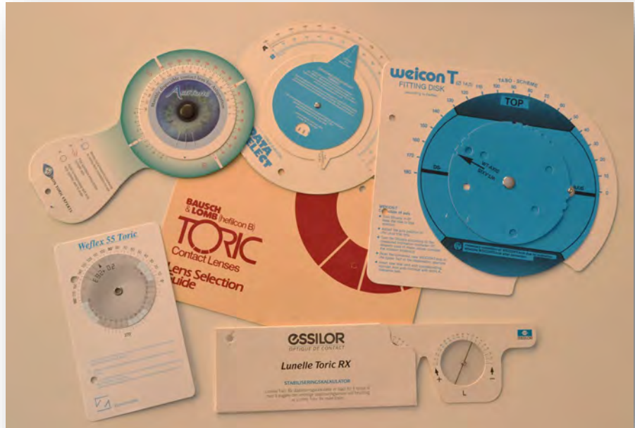
Hjelpemidler til å få riktig akseretning på tidlige generasjoner myke toriske kontaktlinser (ca. 1985-1995). (Foto: M. Helland)
