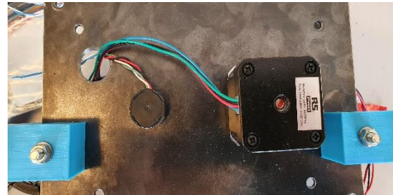
Figur 15: Kabling over midstrukturen for motor og enkoder til rotasjon.
