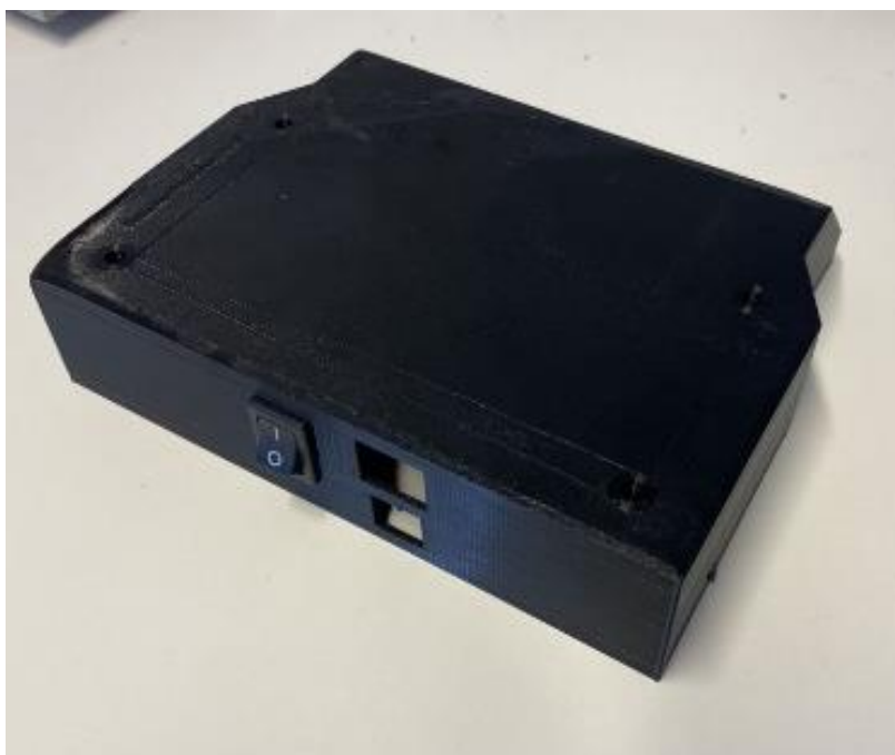
Figur 60: Deksel for å skjule mekanismer og elektronikk.
