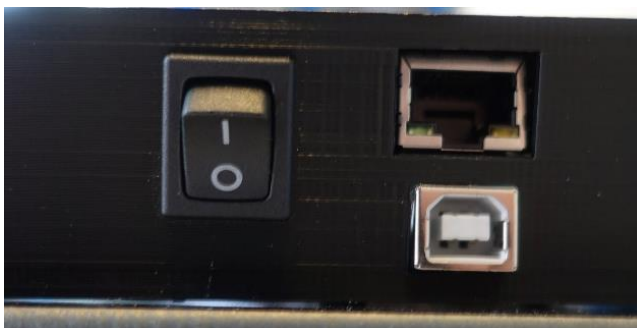
Figur 23 Bryteren for elektrisk sikring av prosjektilene i toppstrukturen
