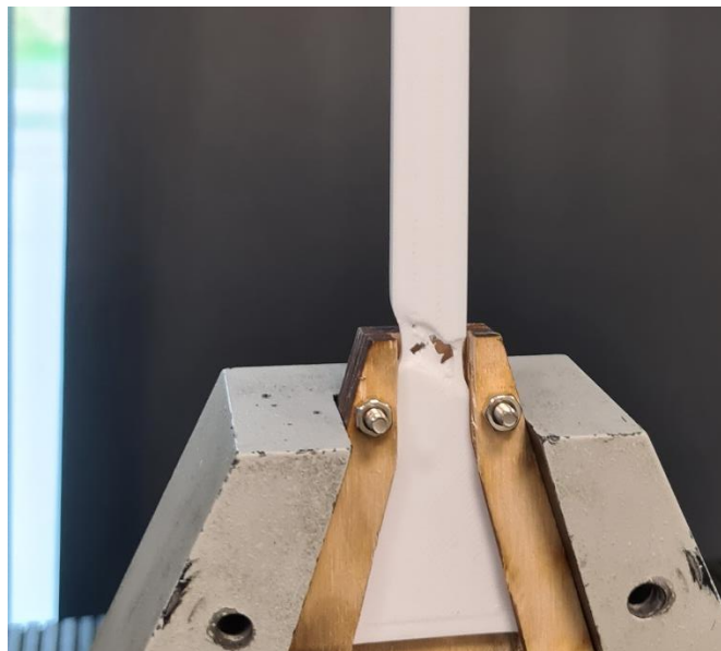
Figur 18: Duktilt brudd i strekkmaskin.
