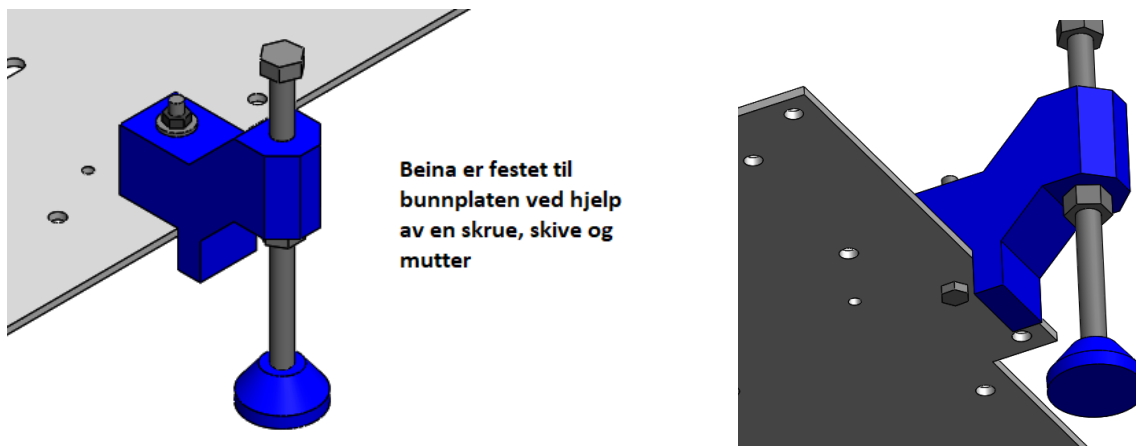
Figur 3: Montering av beinsammenstilling
