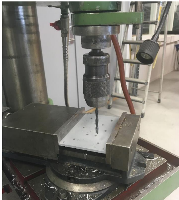
Figur 28: Oppboring av hull i frontplate.
