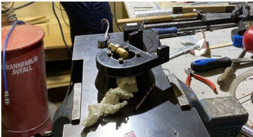
Figur 58: Viser rotasjonsbase og lufttilkobling montert på bunnplate.
