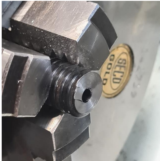
Figur 39: Kappet ned snekkeskrue.
