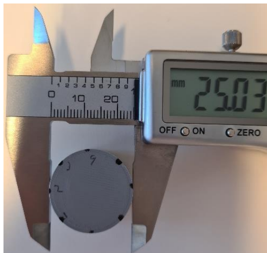
Figur 6: Universal målemetode av sirkeltoleranser.
