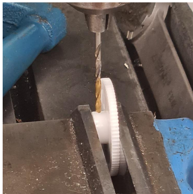
Figur 42: Hull for settskrue i POM-tannhjul
