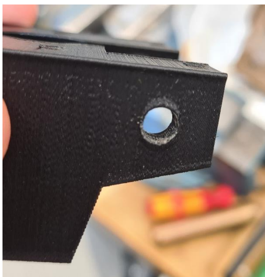
Figur 44: Boret ut hull til aksel for 0099 Bukk topp.
