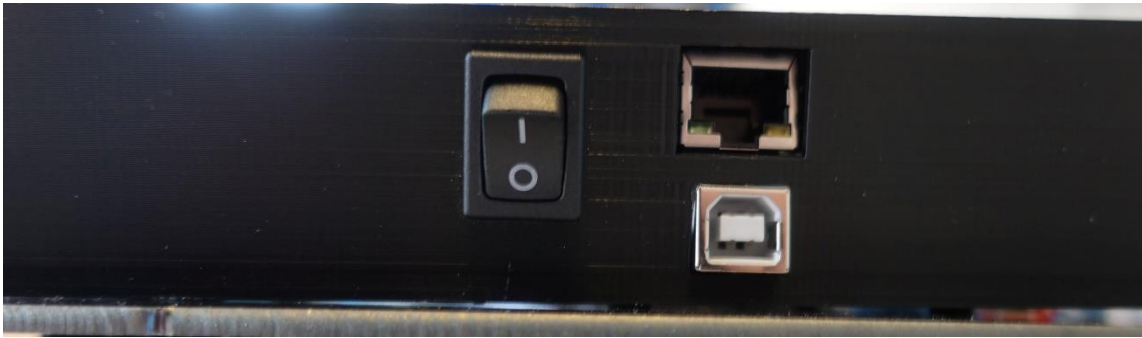
Figur 44: Sikkerhetsbryter, Ethernet-tilkobling og USB-port.
