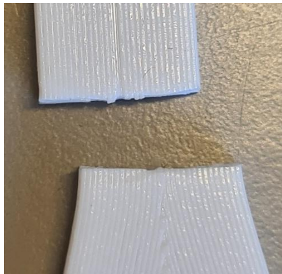
Figur 17: Sprøtt brudd i prøvestav.
