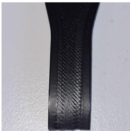
Figur 13: veggtykkelse på seks vegger og 100% innfyllingsmateriale.
