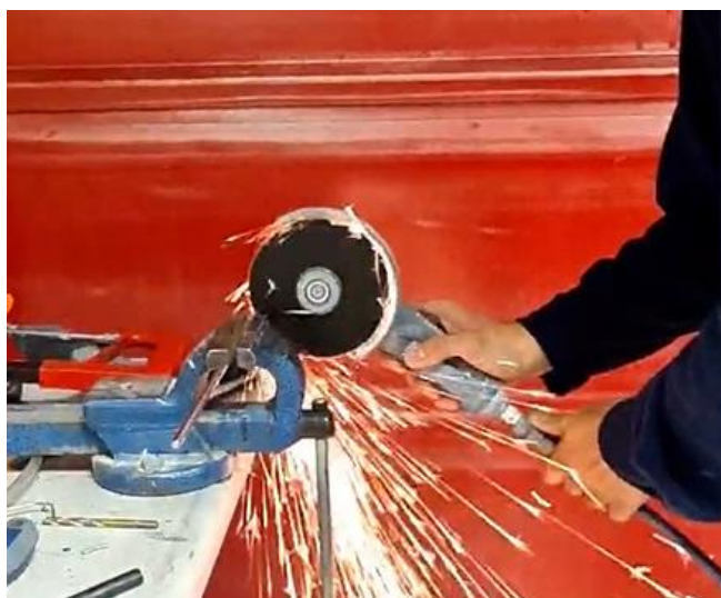
Figur 43: Kutt med vinkelsliper.
