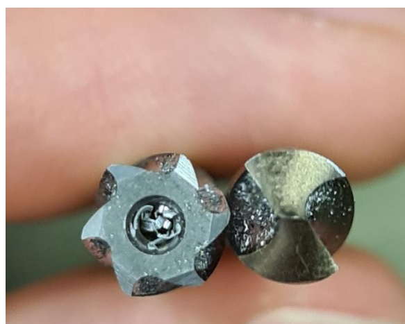
Figur 38: Forskjell på bor og brotsj.
