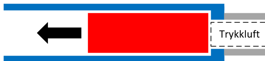
Figur 4: Prosjektil inne i avfyringsrør/løp.
