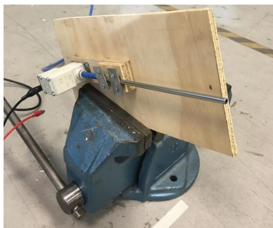
Figur 2: Magnetventil og avfyriingsrør.
