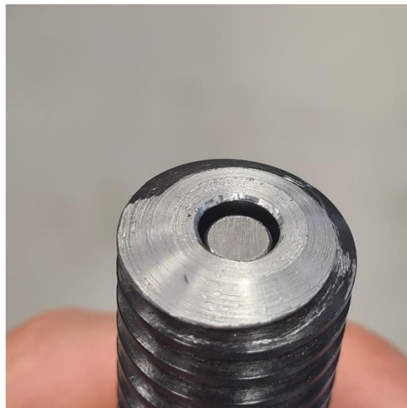
Figur 40: Filt og forsenket snekkeskrue.
