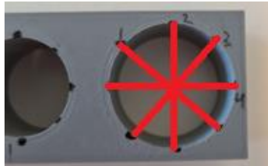
Figur 4: Samsvarende streker for skyvelære målinger.
