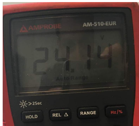
Figur 5: Spenningen målt ut fra spenningsomformeren.
