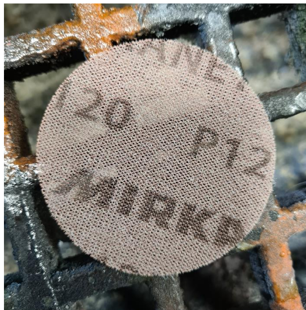
Figur 23: P120 pussepapir til luftdrevet pussemaskin.
