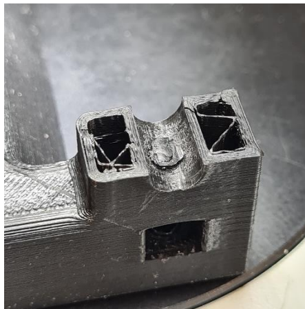
Figur 52: Innvendig mønster i brakett.
