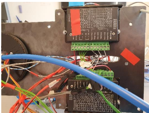
Figur 17: Motordriverne montert i bunnstrukturen.
