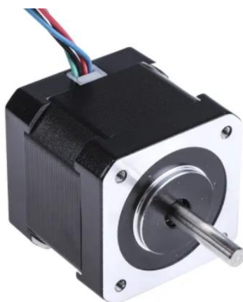
Figur 47: Gammel steppermotor til elevasjon. [8]
