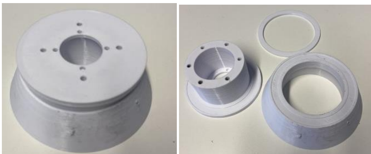
Figur 56: Rotasjonsbase og festes til bunnplate.
