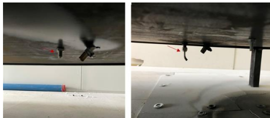
Fig. 2. Nozzle: left 90°, right 45°.
