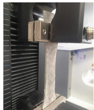
Fig.25 - Tensile strenght test
