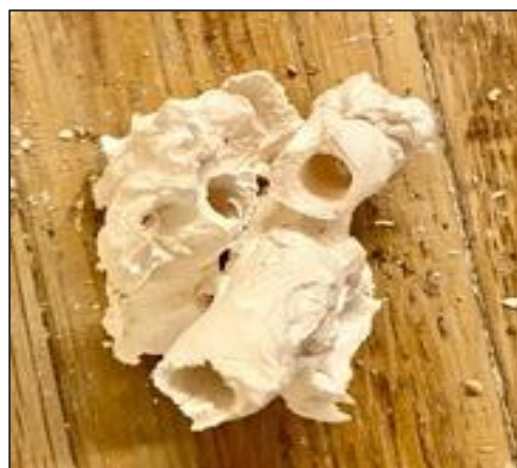
Figur 46 Andregangs råbrann, etter å ha satt sammen brukne biter etter første råbrann.
