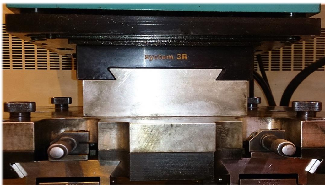
Figur 10. System 3R - Svalesspor teknologi
