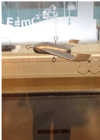
Figur 34 - Festeanordning i vindtunnel
