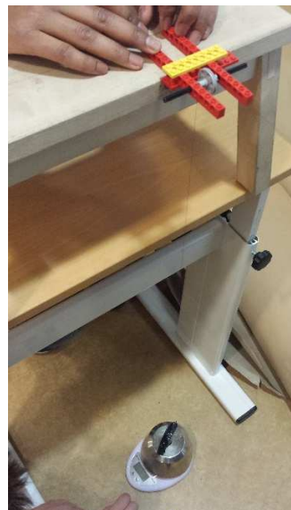
Figur 36 - Trinsesystem for måling av luftmotstand
