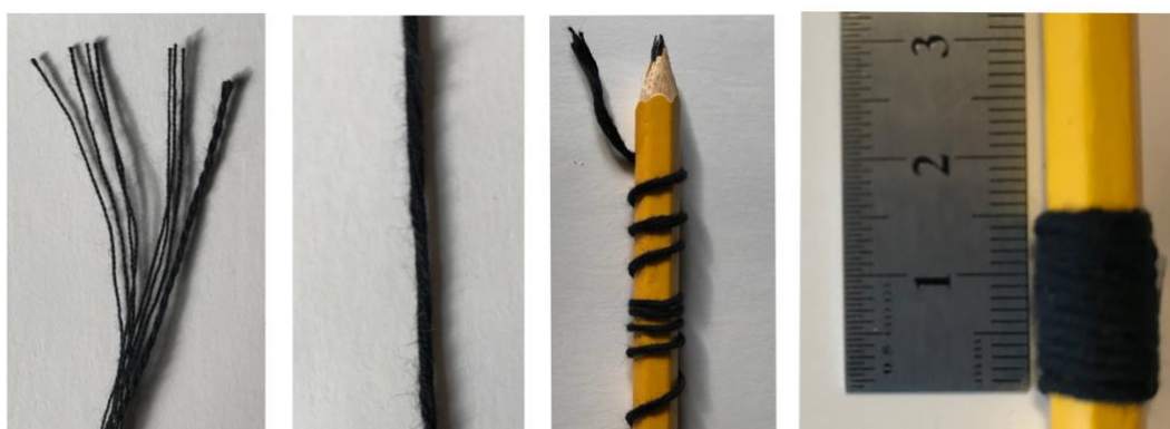
Figur 6:9. 2020 Målemetode for samlet tykkelse på innslagstråd , eget foto.
