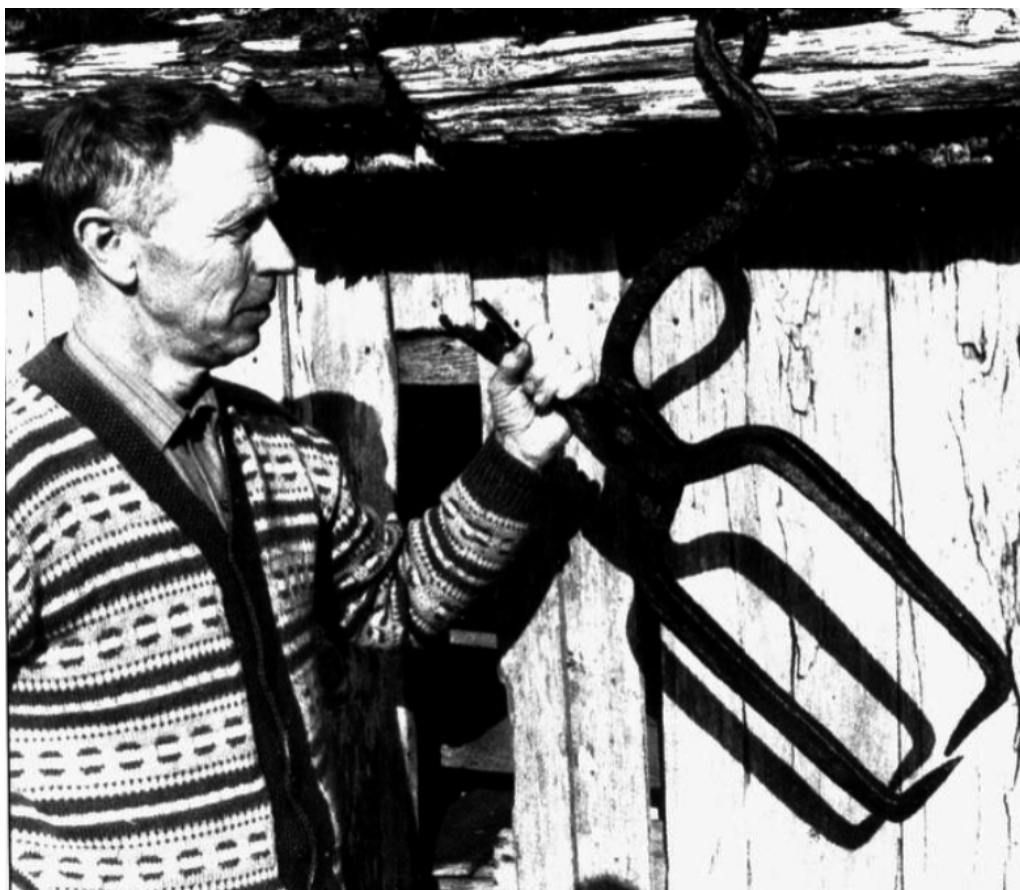
Illustrasjon 4: Då «Albion» forliste utanfor Uksnøy i 1830, var lokalfolk raskt ute for å hjelpe. Bergingsarbeidet var krevande. Ifølge etterkomar Rasmus Løvøy (siste fastbuande på Uksnøy, 1958) blei denne jernkloa smidd for å grabbe jernstenger som låg på havbotnen etter forliset. Frå privat samling med løyve.
