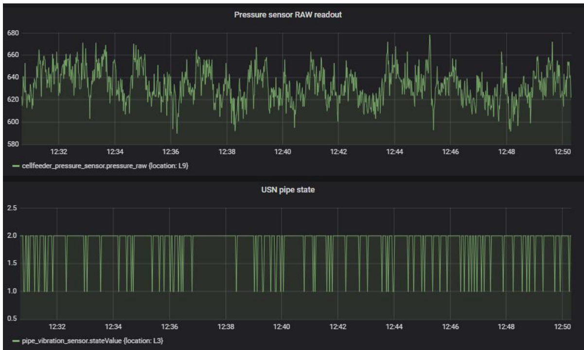
Figur 3-2 - Utklipp av linjestatus gitt av IoT-enhet og rådata fra trykkmåling ved andre test. Leseveiledning for graf finnes i kapittel 2.10, og informasjon om «USN pipe state» og «Pressure sensor RAW readout» i Tabell 2-6.
