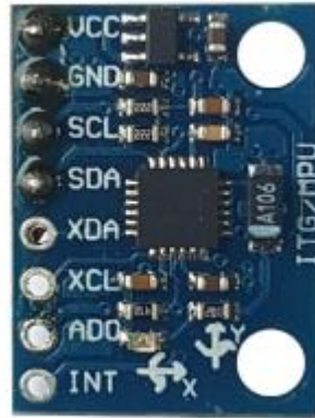
Figur 2-11 - Akselerometeret GY-521 MPU-6050 brukt i prototypen [15].
