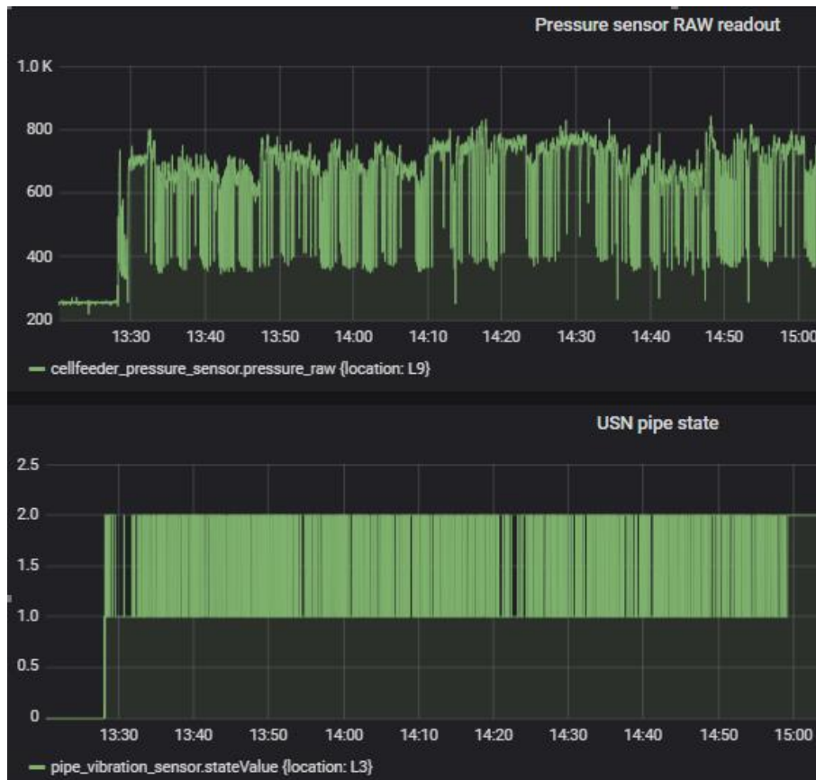
Figur 2-23 – Sammenstilling av måledata. Den øverste grafen viser rådata fra Inovyn sin trykksensor i transportrøret (Pressure sensor RAW readout). Langs y-aksen er amplitude og langs x-aksen er klokkeslett. Den nederste grafen viser tilstandene fra IoT-enheten langs y-aksen (USN pipe state). Langs y-aksen er tilstand, i henhold til tabell Tabell 2-6. Langs x-aksen er klokkeslett.
