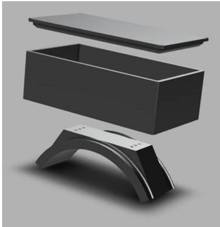
Figur 2-16 – 3D modell av innkapslingen som består av lokk, kabinett og festeanordning. Modellen er tegnet av Inovyn med Fusion360 og printet av Inovyn.
