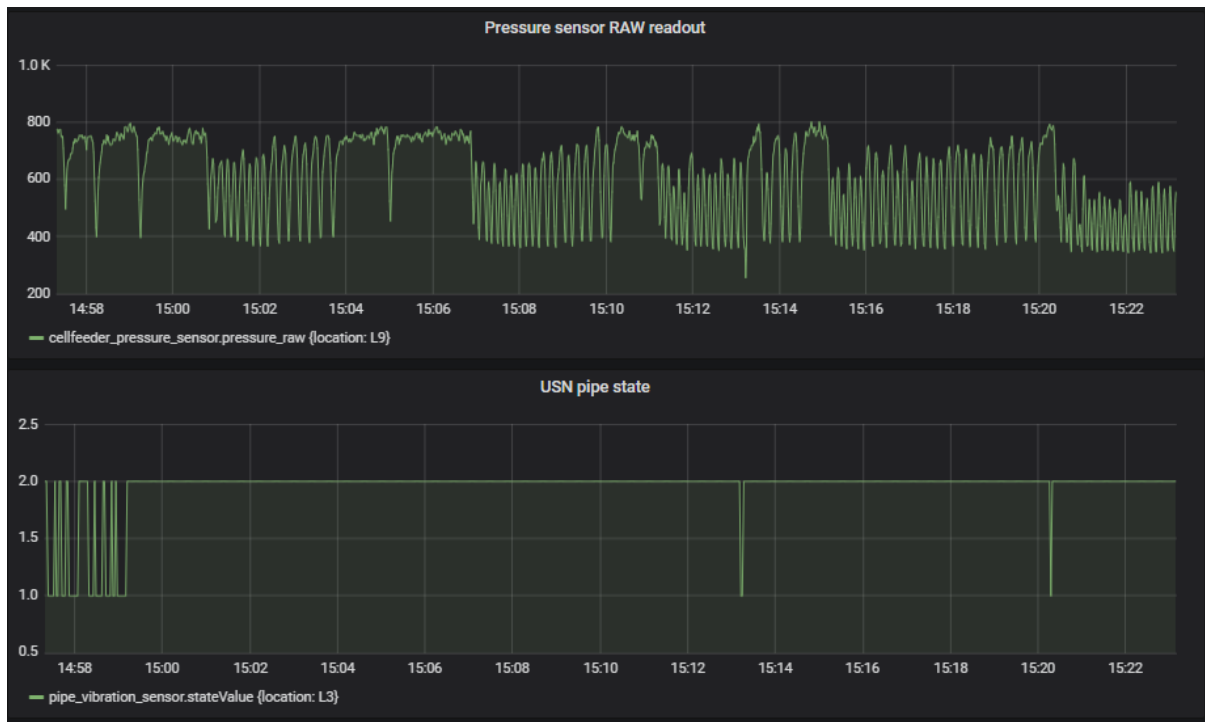
Figur 3-4 - Utklipp av linjestatus gitt av IoT-enhet og rådata fra trykkmåling ved tredje test, med nytt referansebilde for «pulver». Leseveiledning for graf finnes i kapittel 2.10, og informasjon om «USN pipe state» og «Pressure sensor RAW readout» i Tabell 2-6.
