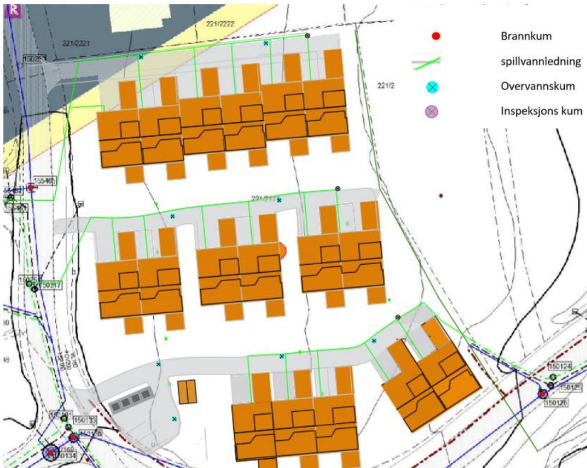
Figur 3.10 Tegning for spillvannlednings tilkobling
