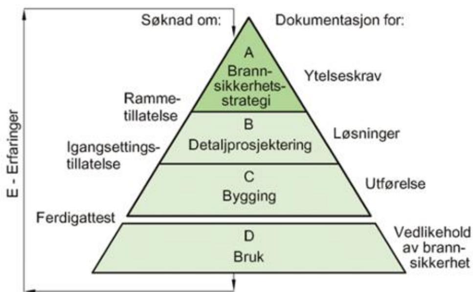
Figur 4.1 Nivåer for dokumentasjon av brannsikkerhet [9]
