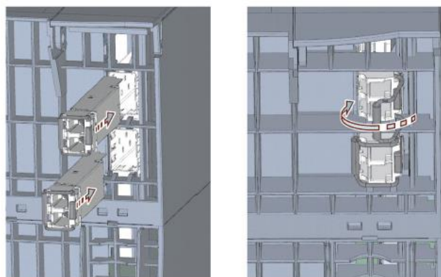
Figur 3.18: Montering av synkroniseringsmodul på CPU. [9]
