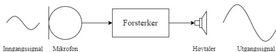
Figur 8.1.: Eksempel på sensor som lydforsterker.
