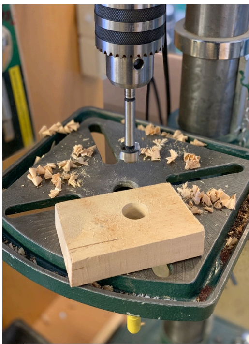
Bilde: 16 Jeg skal bore helt igjennom øverste del og gjør en test for å se hvordan det blir på håndtaket og for å velge riktig bor. Eget foto.
