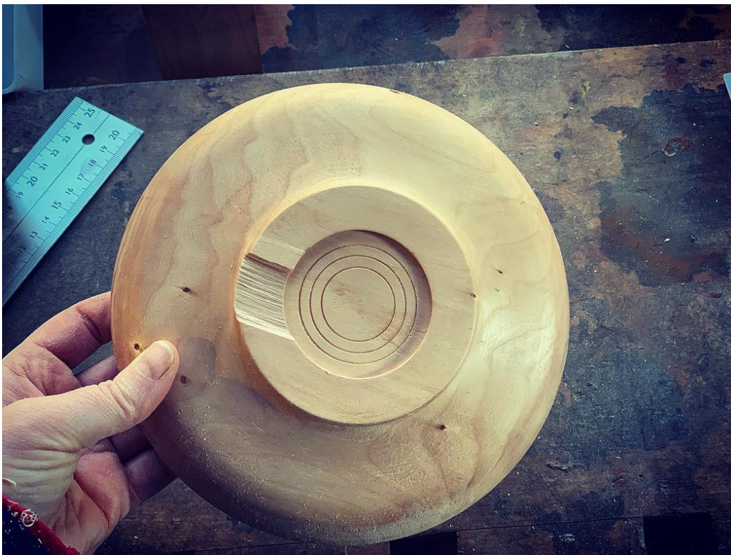
Bilde: 34 Asjett i selje #8. Knakk av festet fordi jeg fikk et hogg. Eget foto.
