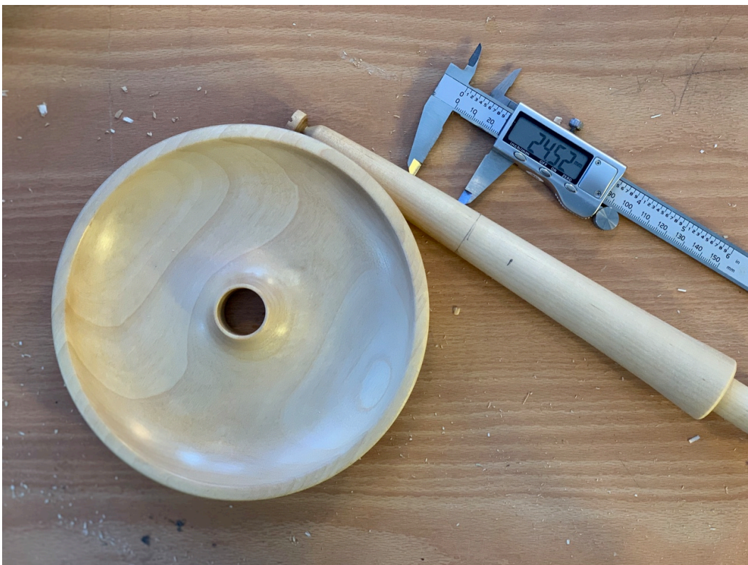
Bilde: 18 Her har jeg markert hvor jeg skal dreie på håndtaket. I stedet for å dreie kon på fatet dreier jeg rett med en meisel på håndtaket, dette gir også en hylle som støtter øverste del. Eget foto.
