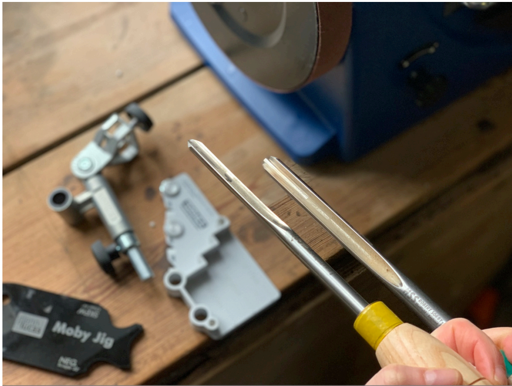
Bilde: 26 Formskulp og bollejern trenger og slipes. Eget foto.
