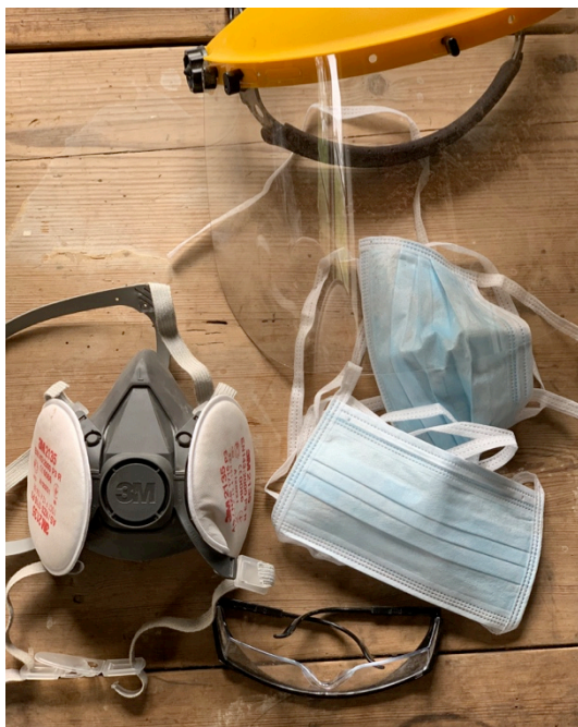
Bilde: 30 Skjerm, brille og masker. Her bruker jeg en buet skjerm. Maske bruker jeg når det er mer støv, som når jeg pusser gjenstanden med pussepapir. Eget foto.
