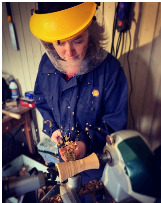
Bilde: 30 Skjerm, brille og masker. Her bruker jeg en buet skjerm. Maske bruker jeg når det er mer støv, som når jeg pusser gjenstanden med pussepapir. Eget foto.
