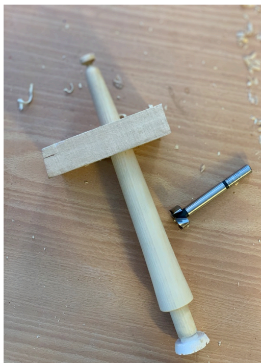
Bilde: 16 Jeg skal bore helt igjennom øverste del og gjør en test for å se hvordan det blir på håndtaket og for å velge riktig bor. Eget foto.
