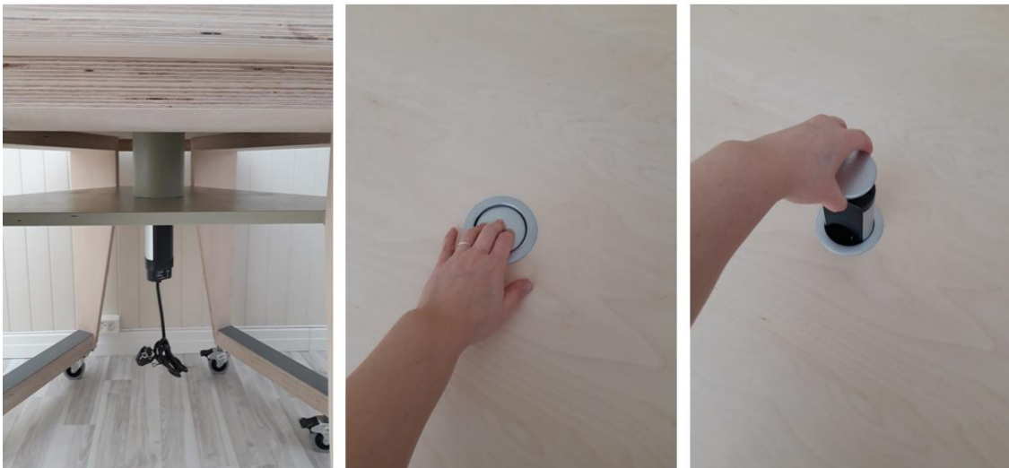
Figur 63. Nærbilde av strømuttak under og over arbeidsflaten til modul to.
