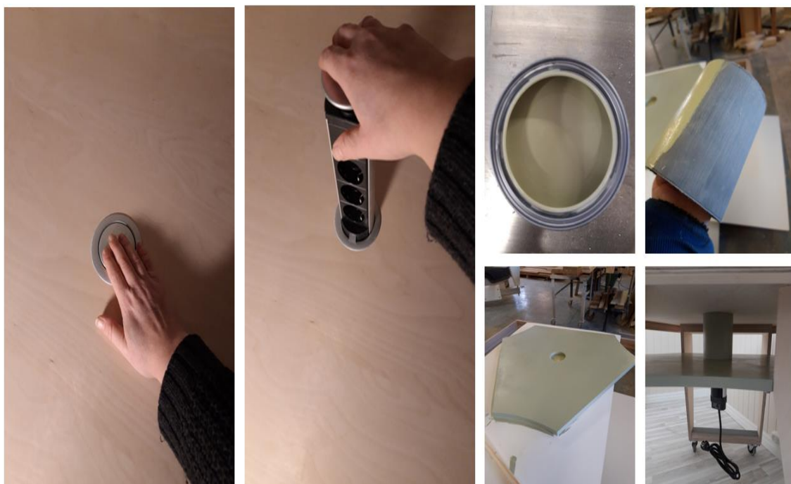
Figur 59. Hvordan strømuttaket fungerer og hvordan hyllene under arbeidsflaten ble malt og festet.
