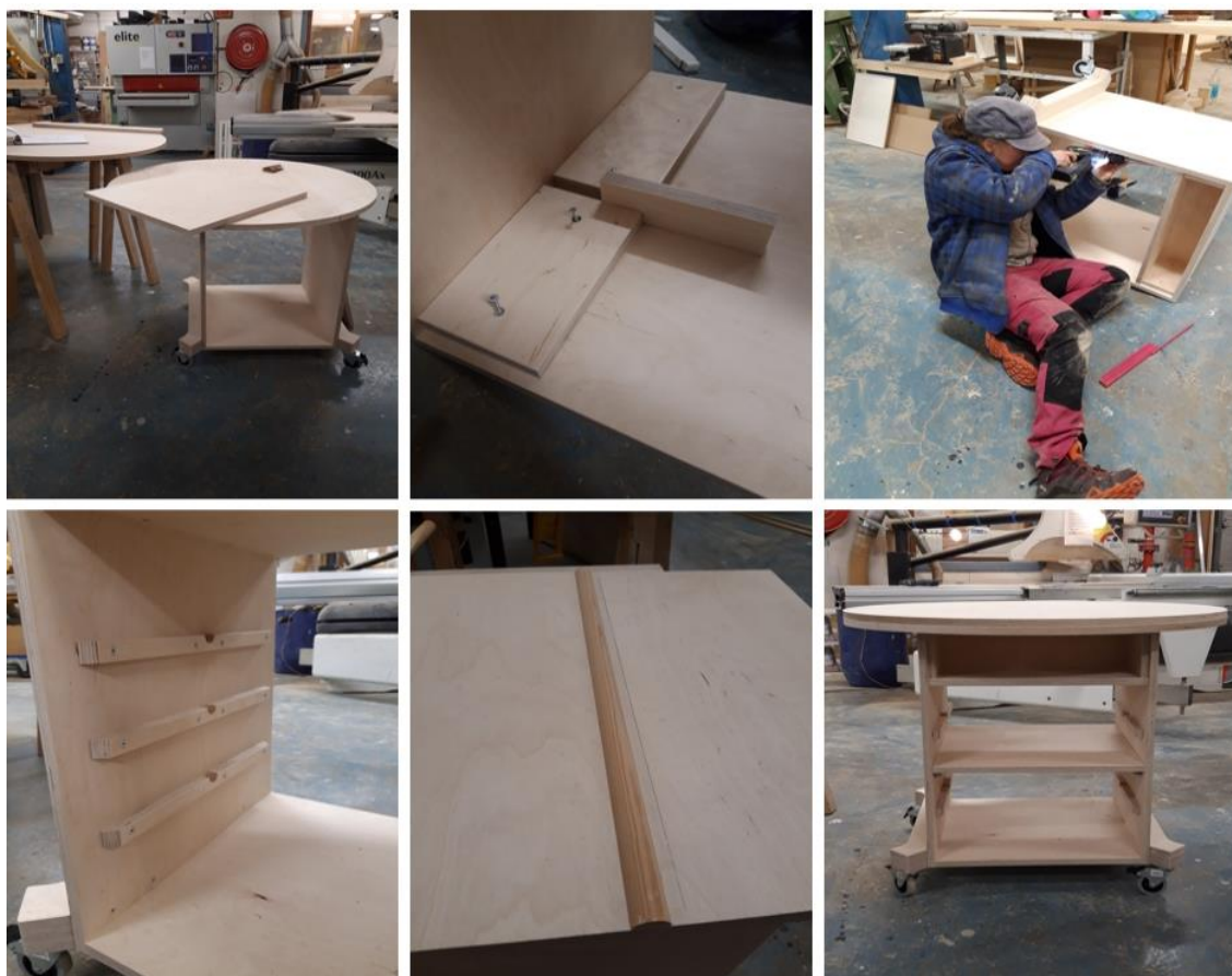
Figur 44. Hvordan understellet på modul en er bygget.
