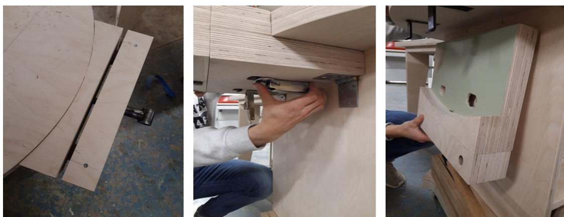
Figur 41. Skrustikkens fleksibilitet. Bildene viser hvordan skrustikken lett kan flyttes etter behov.
