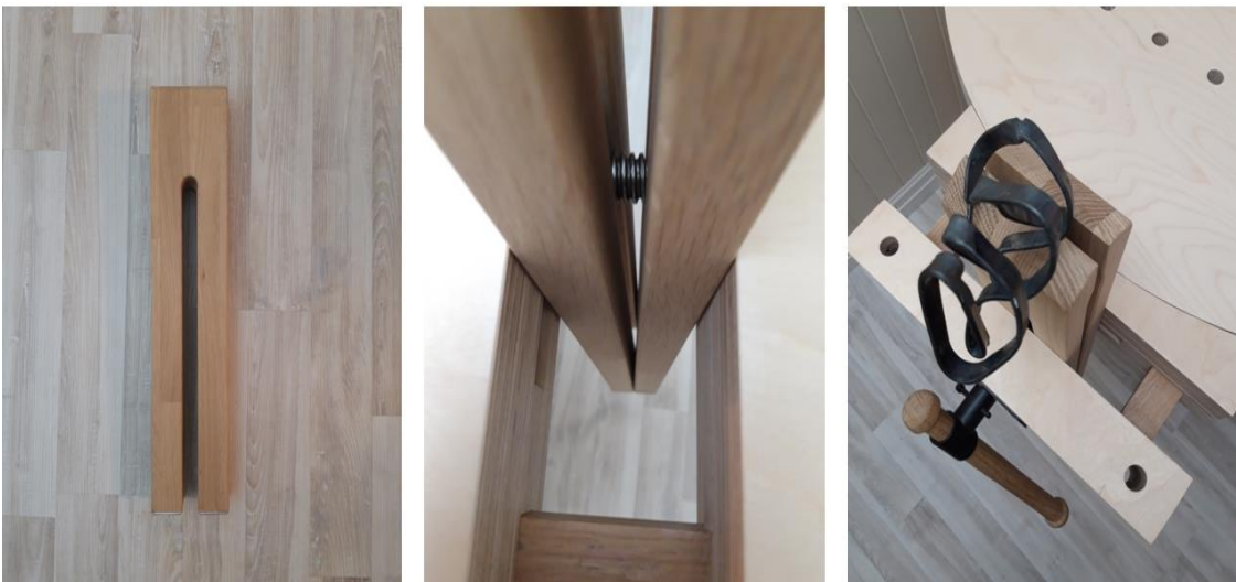
Figur 47. Filklemme og hvordan filklemmen kan brukes i skrustikken på modul en
