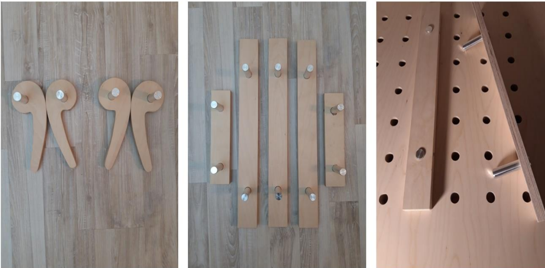
Figur 46. Ulike holdere til festehullene på arbeidsbordet til modul en. De ulike holderne gir forskjellige festemuligheter
