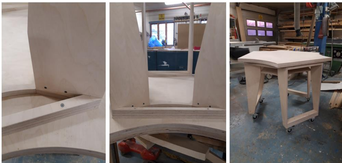
Figur 57. Hvordan forsterkningslisten ble montert og hvordan modul to ser ut med lister og hylle.
