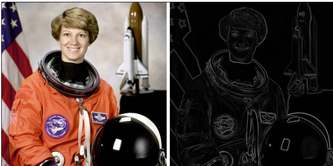
Figure 4 Example of Sobel Edge Detector (Kapur, 2017)
