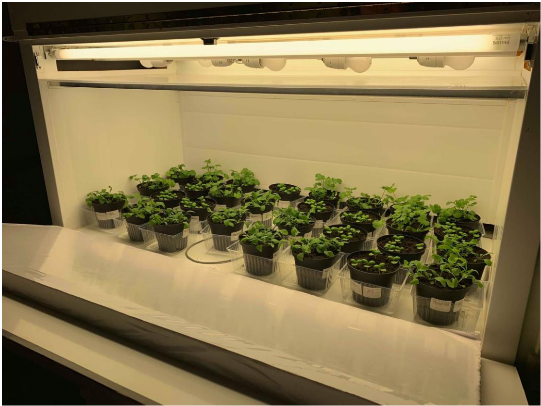
Figur 6: Vekstkammer med lysstoffrør som lyskilde der andre ytre faktorer er under kontroll.
