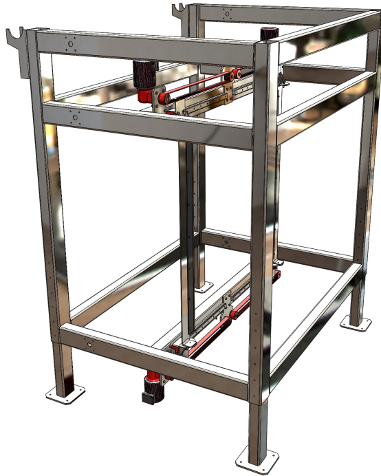
Figur 15: Vertikale rulle med integrert pneumatikk
