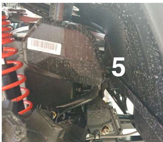
Figur 30: Beskyttelsesdeksel over bakdekk festes med plugg nr. 5 i frem- og bakkant
