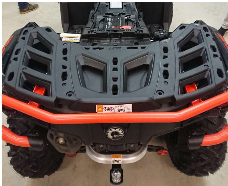
Figur 9: Bilde av ATV med montert fanger og bagasjebrett.
