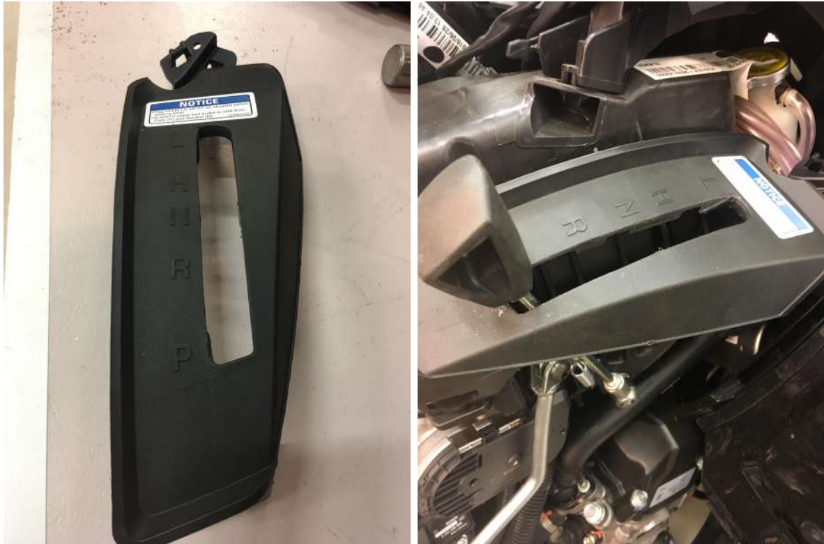
Figur 183: Dekselet er sagd slik at det er klarere bane for LA14
