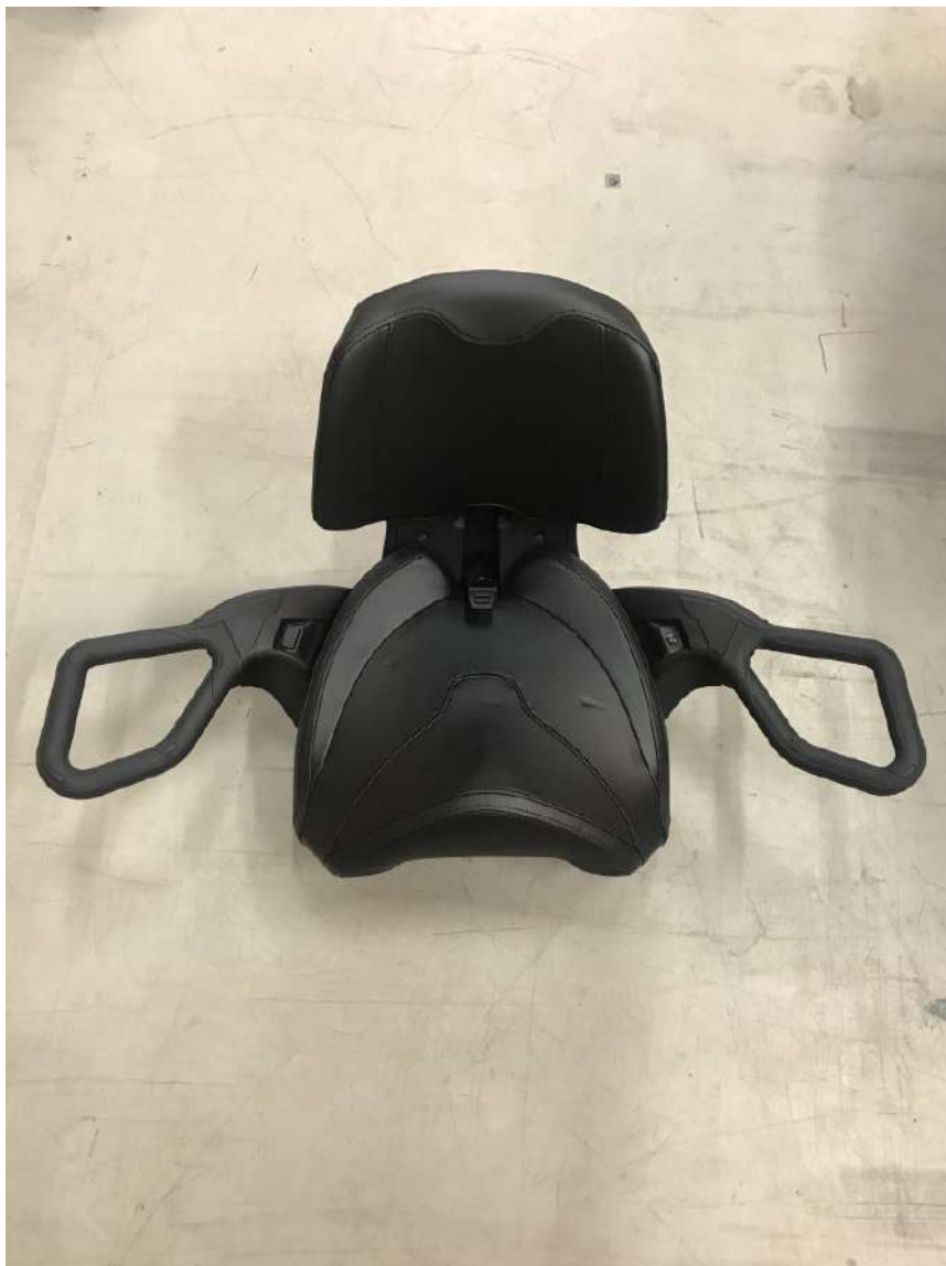
Figur 35: Passasjersete, festes i stang som forklart under figur 32
