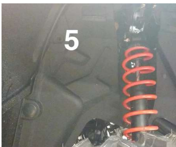
Figur 28: Deksel til fothviler festes sammen med beskyttelsesdeksel over både frem- og bakdekk med skrue nr. 6
