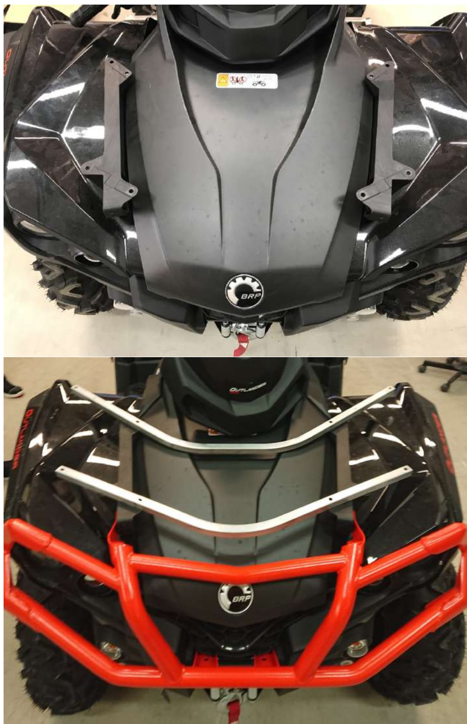
Figur 4: Bilde av ATV uten fanger og bagasjebrett, samt med montert fanger og feste til bagasjebrett. Bagasjebrettet festes med skruer i festestengene.
