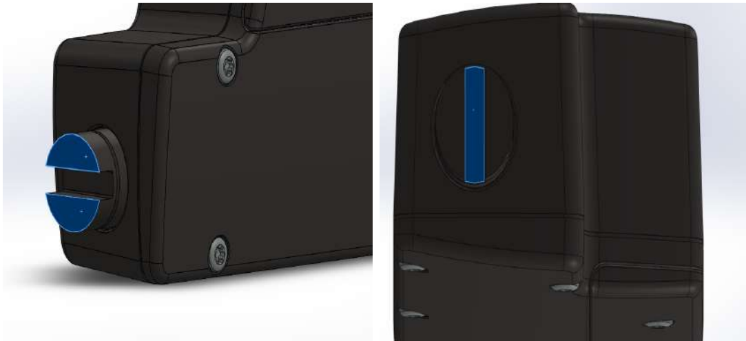
Figur 182: De blå tverrsnittene viser hvor LA14 blir utsatt for bøyespenninger.
