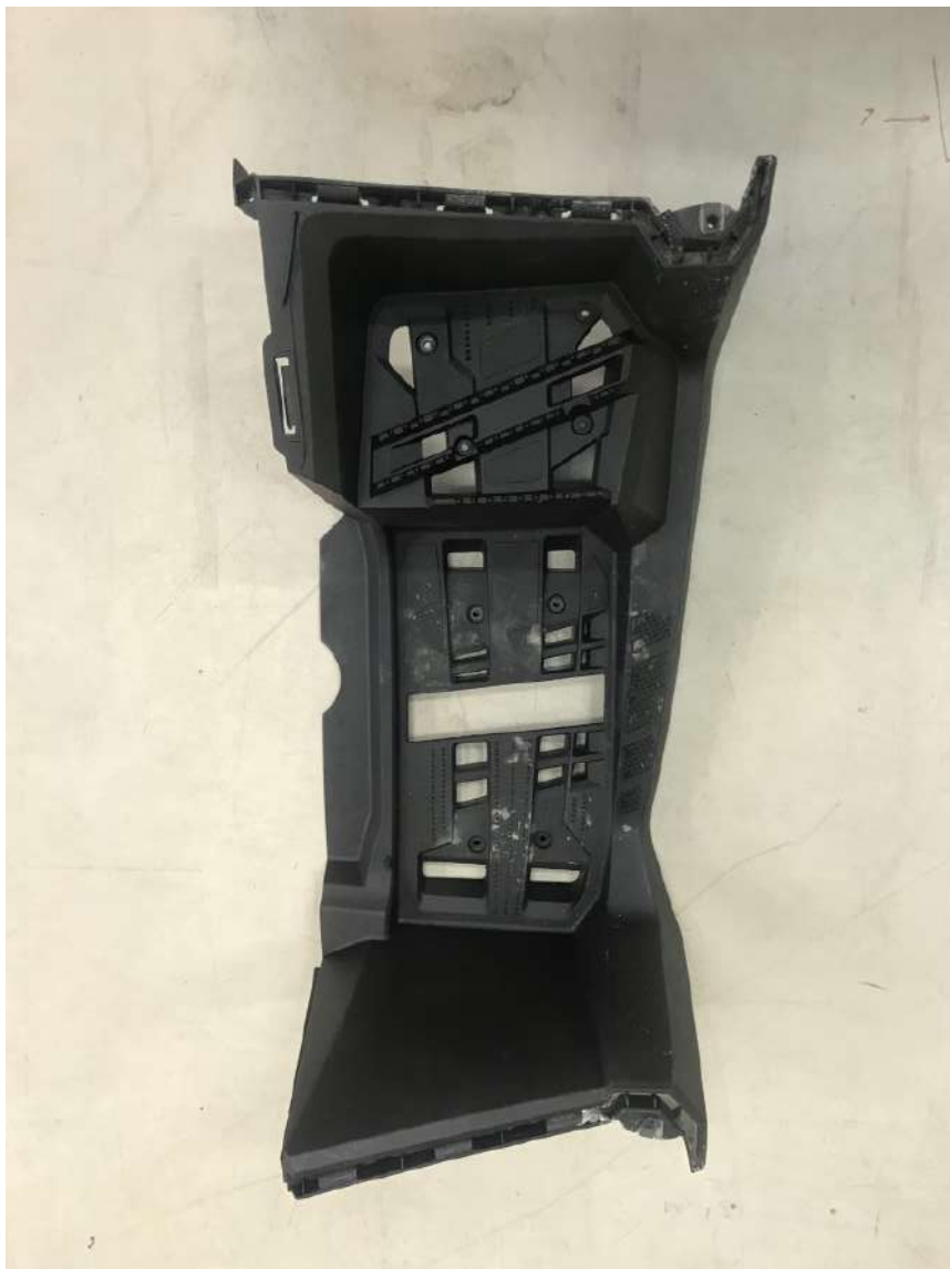
Figur 22: Beskyttelsesdeksel til fothviler - festes sammen med feste til fothviler i figur 21
