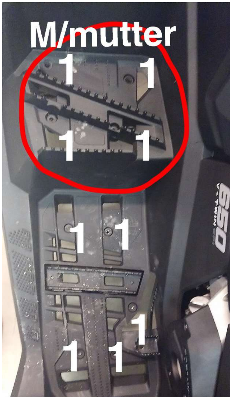
Figur 27: Skruveoversikt for feste av fothvilere - festes med 9 × skrue nr. 1, hvorav 4 av disse skal ha mutter.
