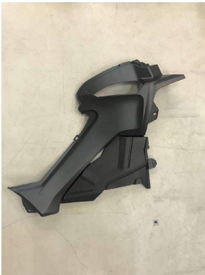
Figur 16: Beskyttelsesdeksel høyre side av ATV - Festes med plugg nr.5 og skrue nr. 6
