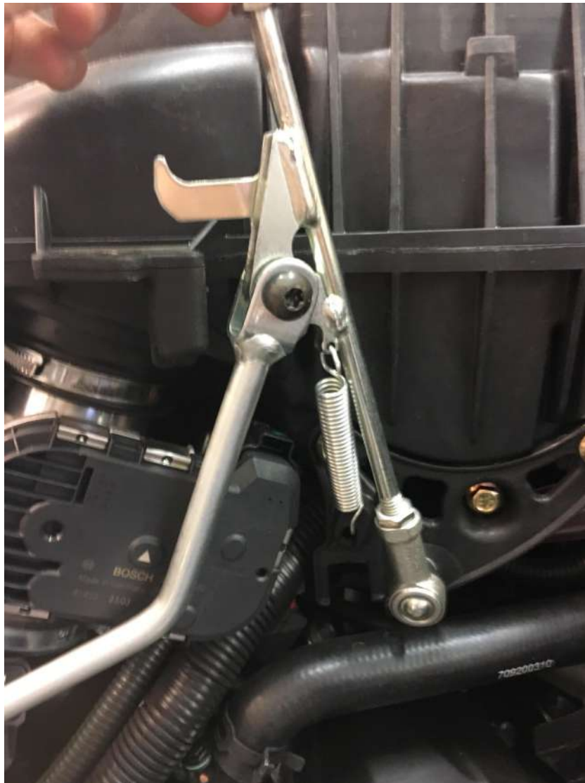
Figur 184: Dekselet er sagd slik at det er klarere bane for LA14
