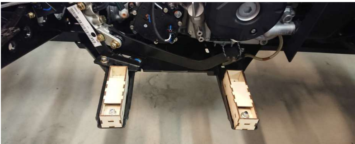
Figur 20: Festepunkt for fører-fothviler med laserkuttete testklosser montert
