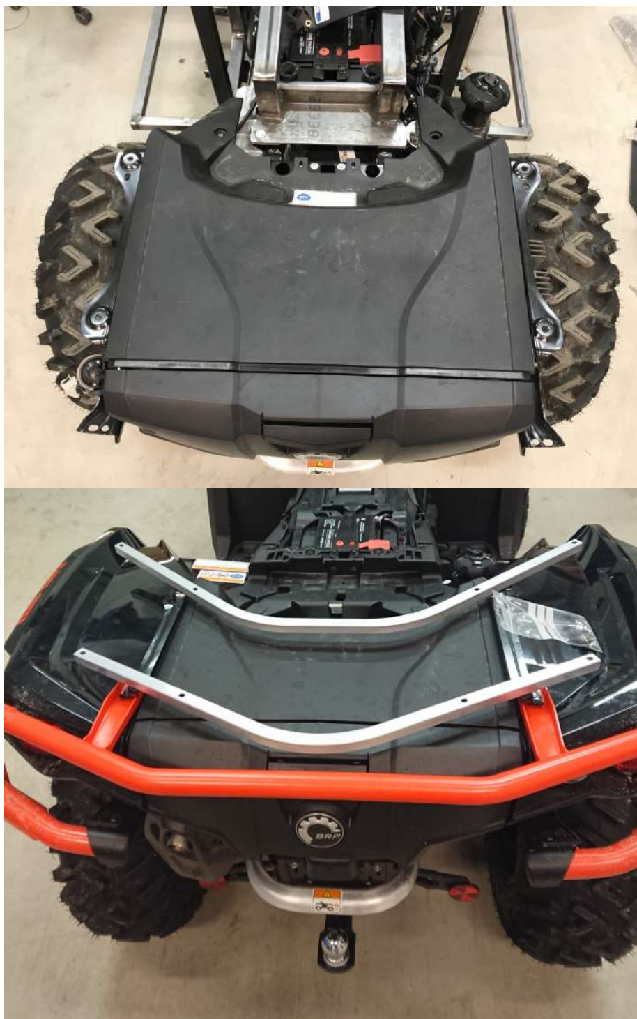
Figur 8: Bilde av ATV uten fanger og bagasjebrett, samt med montert fanger og festestenger til bagasjebrett. Festestengene skal festes i de fire ledige hullene i øvre bildet, bagasjebrettet festes videre i disse som vist i figur 9
