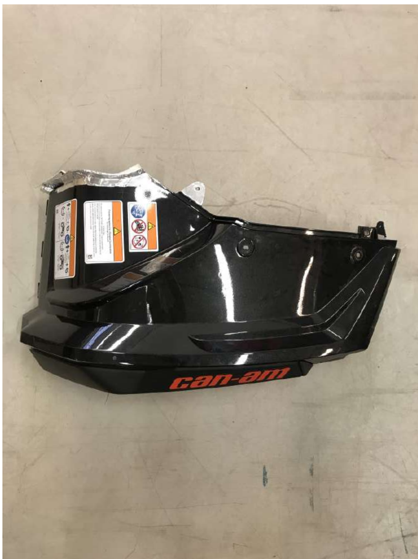
Figur 25: Hjulbue - beskyttelsesdeksel over bakdekk med innfesting til baklys
