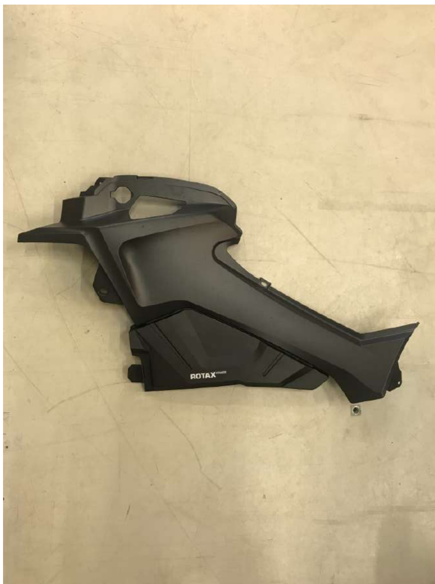
Figur 23: Beskyttelsesdeksel venstre side av ATV - Festes med plugg nr. 5 og skrue nr. 6
