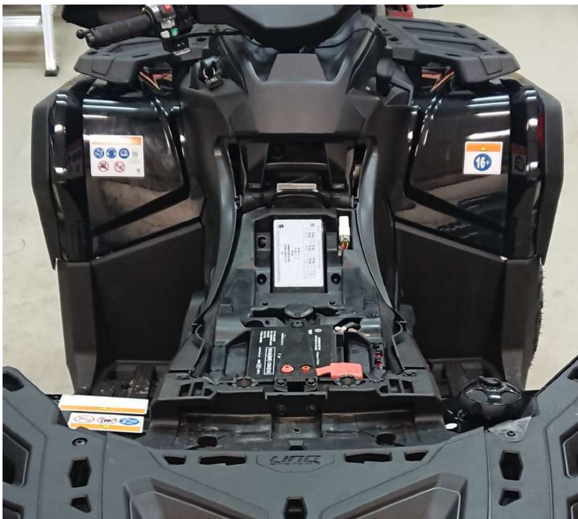
Figur 36: Bilde av ATV med fremre festedel montert, men uten bakre festedel og sete montert
