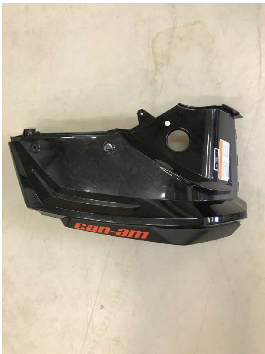
Figur 19: Hjulbue - beskyttelsesdeksel over bakdekk med innfesting til baklyset
