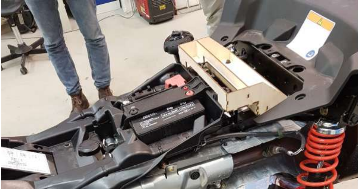
Figur 21: Laserkuttet del for lokalisering av sekundærfestepunktene.
