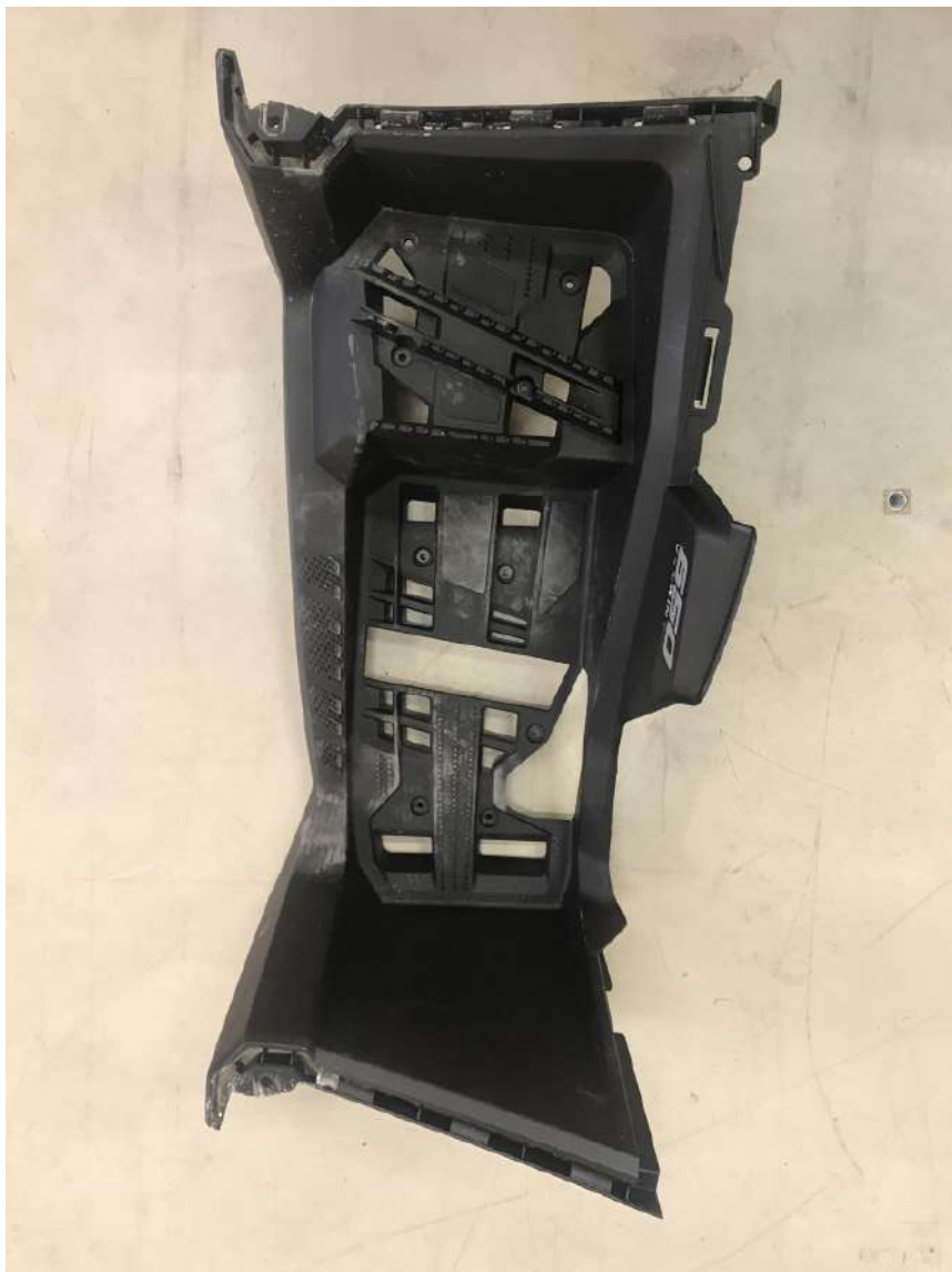
Figur 15: Beskyttelsesdeksel til fothviler - festes sammen med feste til fothviler i figur 14
