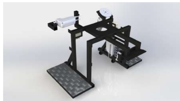
Figur 135: Ferdigstilt ramme med designede komponenter, aktuatorer og steppermotor, sett bakfra
