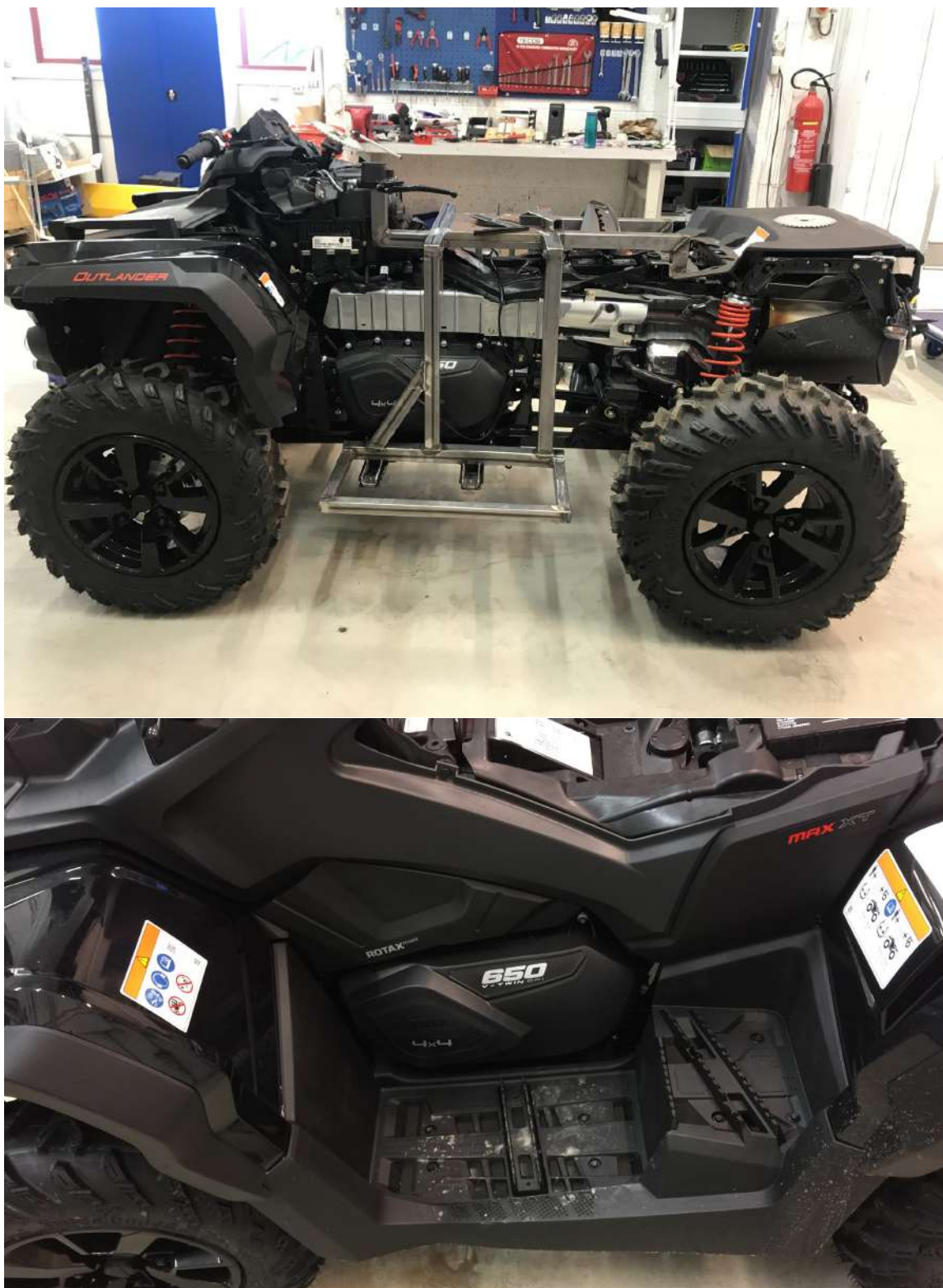
Figur 26: Bilde av ATV uten deksler og fothviler, samt med deksler og fothviler montert.
