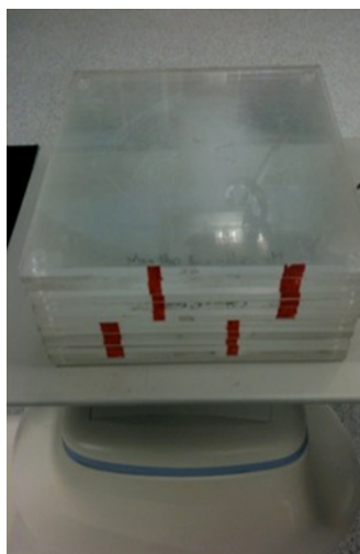
Figur 3: Pleksiglass plater benyttet til å måle huddose plasserte på angiografibordet.
