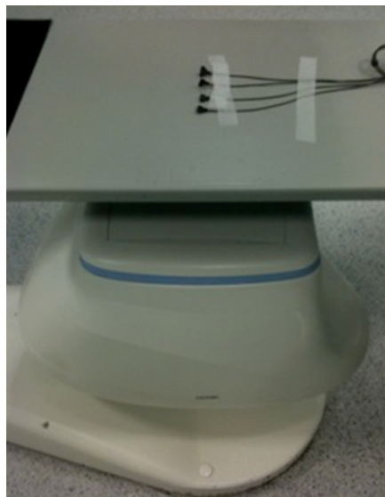
Figur 4: De fire sensorene fra Unfors Patient Skin Dosimeter plassert på angiografibordet.
