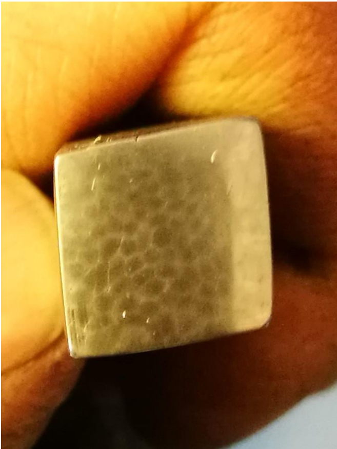
Figur 55 Man kan tydelig se endene på alle de små ståltrådene. Det var dette mønsteret jeg gikk videre med.
