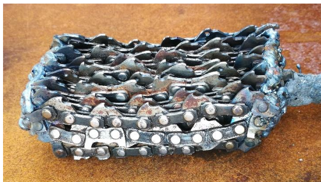
Figur 61 Tre lag av ni lengder sammensveiset til ett emne.
