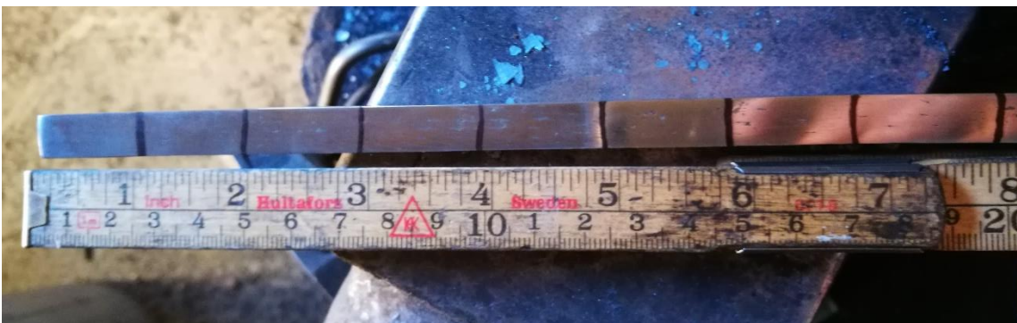
Figur 56 Stangen kuttes opp i åtte like store deler av 2,5cm
