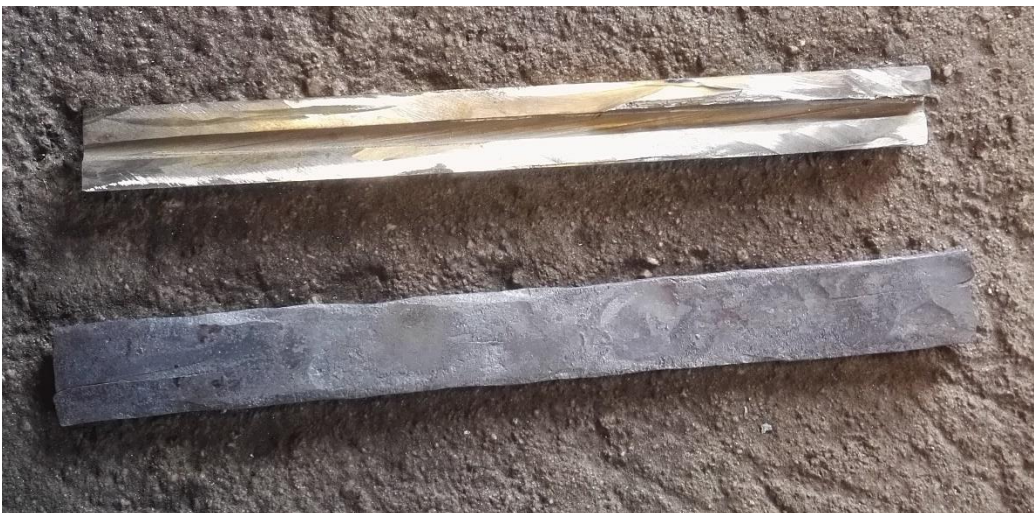
Figur 28 Geværløp delt i to på langs og smidd ned til en flat stang.
