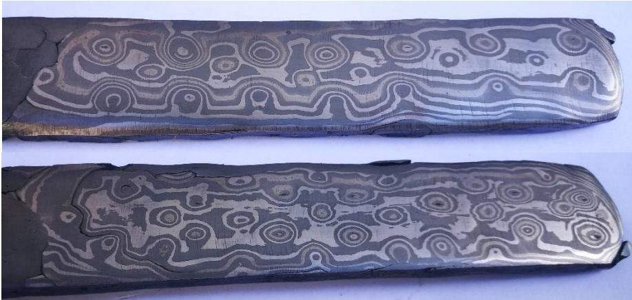
Figur 84 Etter at emnet er smidd ut, slipt og etsset
