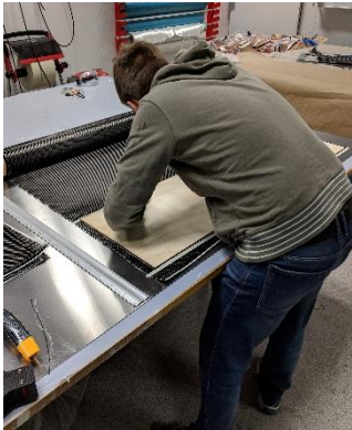
Oppmåling av fiberduk
