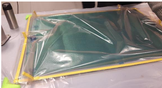
Påføring av plastfilm for å skape rom for vakuum
