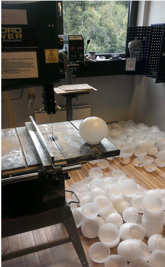
Figur 8 De 450 lyskuppene ble kappet i to med båndsg.
