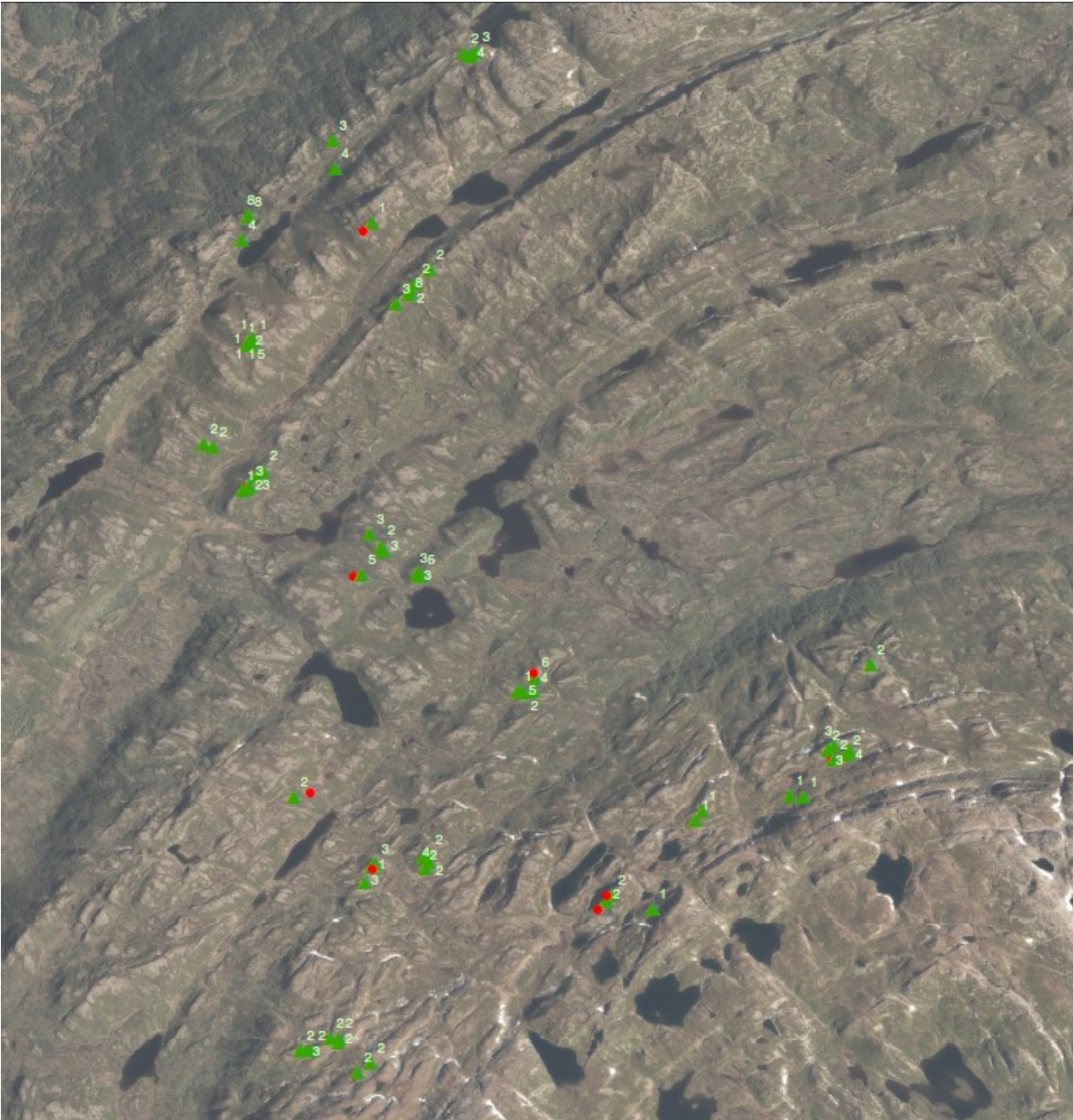
Figur 14. Høyder på lav registrert i felt i Brattefjell-Vindeggen. Gjennomsnittsmåling av lavhøyde innenfor homogene områder, ca. 50-100m 2 , nær observasjonspunkt. Grønne trekkanter angir lavhøyder, røde sirkler angir punkt uten registreringer.
