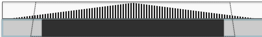
Figur 17 Rasterets utforming med lameller som minker i høyde fra sentrum mot rasterets kanter. Stiplet ramme illustrerer strålefelt brukt i test. Sort boks: liten kassettstørrelse. Grå boks: stor kassettstørrelse. (Egen tegning. Skjematisk, ikke målbar).
