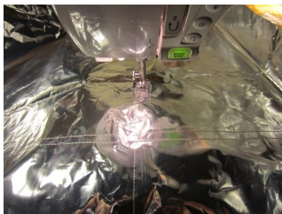
Figur 22. Sammenføring med overlapping og to rettsømmer.
