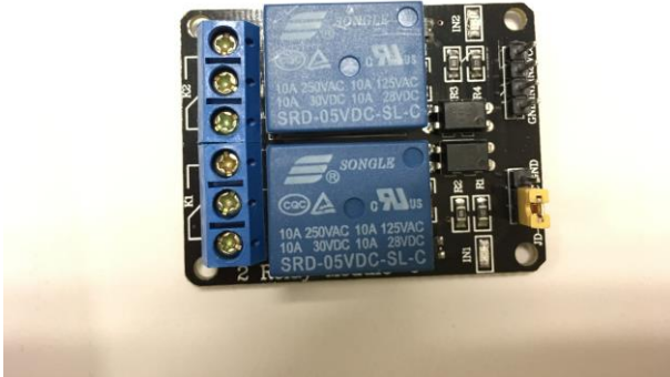
Figur 123 - Bilde av relé
