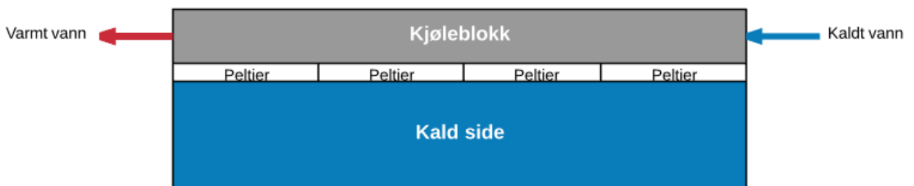
Figur 72 - Kjølesystem, 4x TEC1-12706, vann
