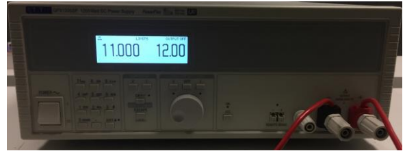
Figur 143 - Lab-strømforsyning. 11.0V konstant spenning, 12.0A begrensning av strømstyrke
