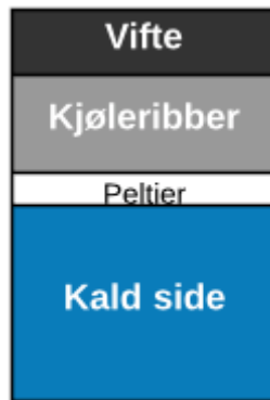
Figur 75 - Et TEC1-12706 element og kjøle ribber av aluminium og vifter
