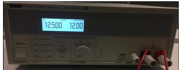
Figur 145 - Lab-strømforsyning. 12.5V konstant spenning, 12.0A begrensning av strømstyrke
