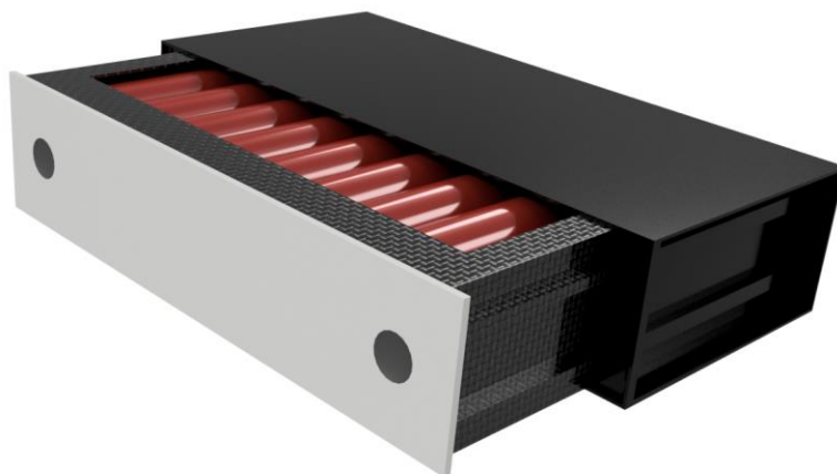
Figur 57 - Visuell fremstilling av 3D modellert batterikassett. Isometrisk visning av front. Med batterier og ramme.
