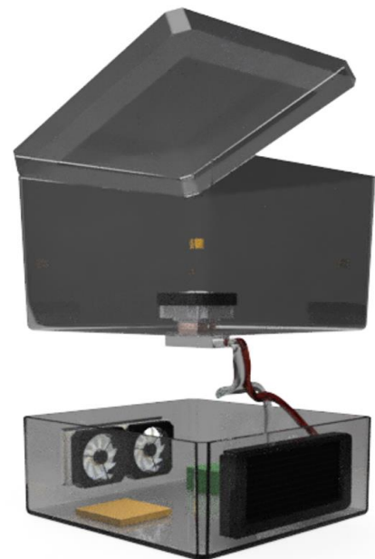
Figur 12 - Før iterasjon 4: Løsning med kjølesystem og elektronikk i egen modul.
