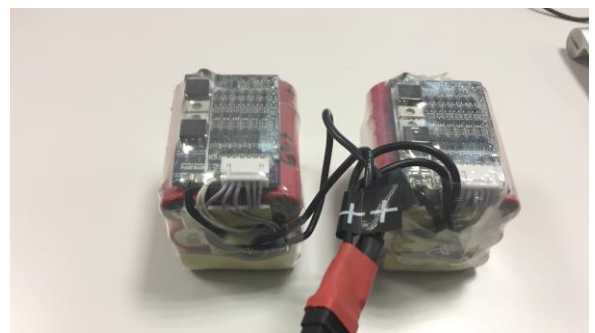
Figur 137 - Bilde av batteripakken med to batterimoduler som er koblet i parallell. Batteripakken har en kapasitet på 21000mAt og potensialforskjell på 10.8V
