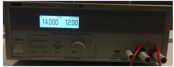
Figur 147 - Lab-strømforsyning. 14.0V konstant spenning, 12.0A begrensning av strømstyrke
