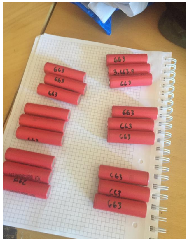
Figur 135 - Oppmåling av potensialforskjell før batteriene ble parallellkoblet
