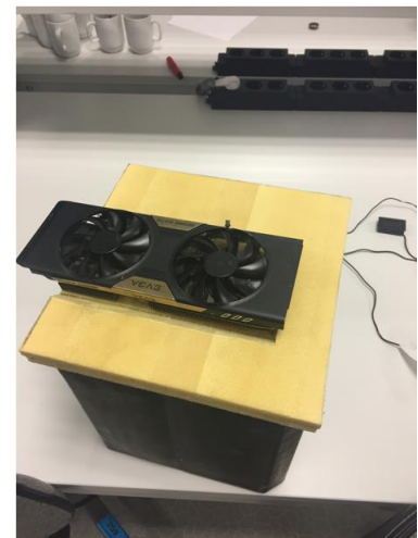
Figur 141 - Prototype 2 av karbonfiber med 20mm PVC isolasjonsplater.
