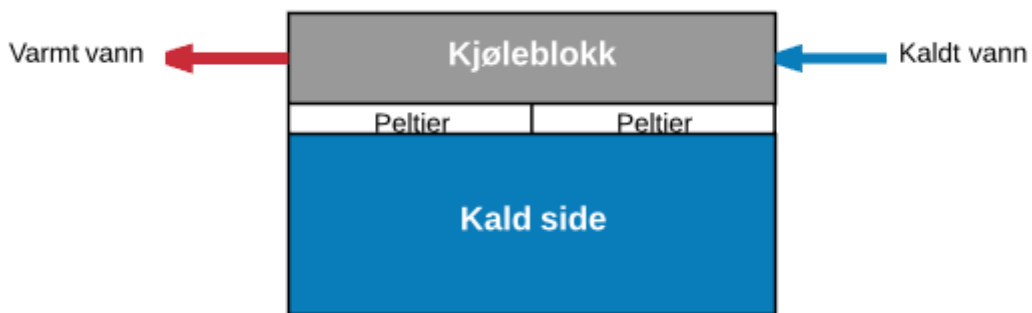
Figur 71 - Kjølesystem, 2x TEC1-12706, vann
