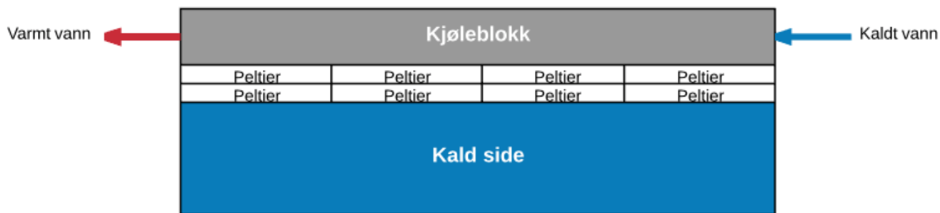
Figur 79 - 8x TEC1-12706 i to seriekoblede serier à fire elementer, vann
