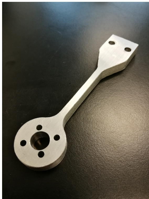
Figur 5.66: Motorfeste ferdig maskinert.
