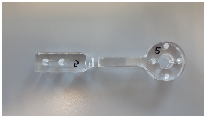
Figur 5.24: Brudd i overgang mellom innspenning og skaft
