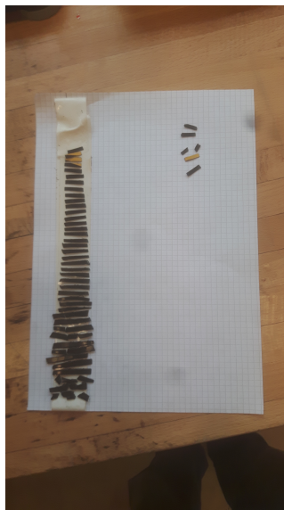
Figur 5.60: DJI 1345-s propell, klippet opp. MERA 2017
