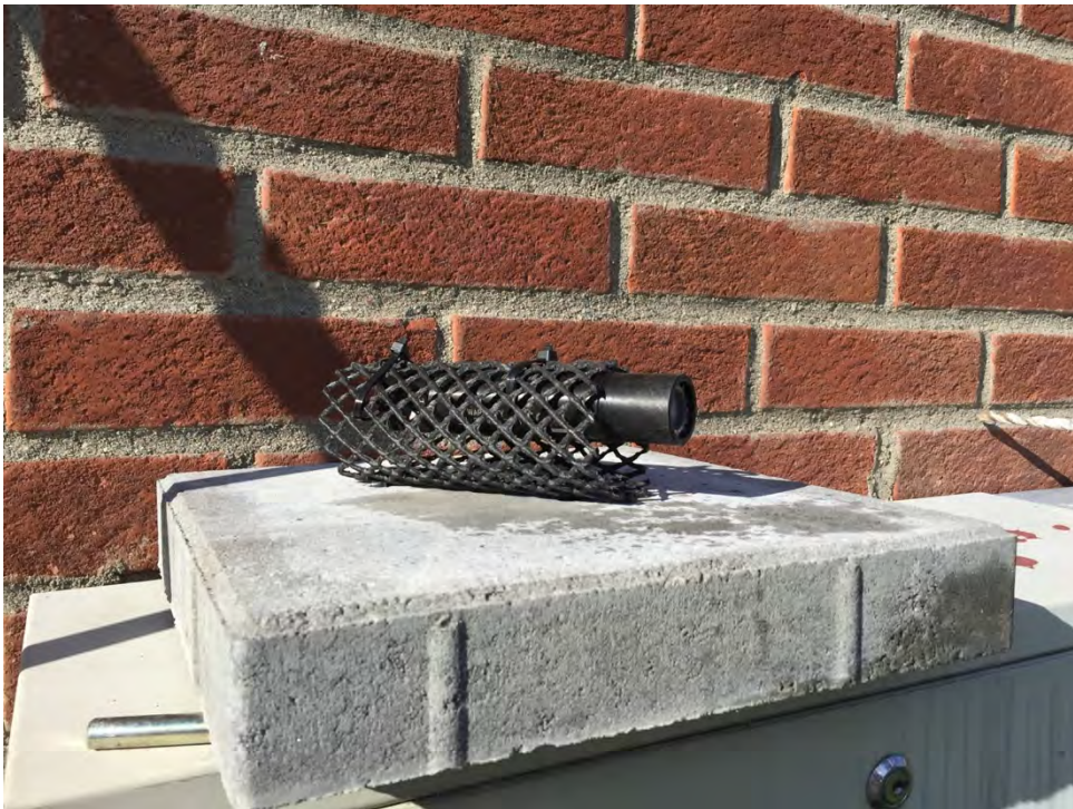
Figur 4-1. Ledningsevneloggeren montert på en betongplate. Plastrøret loggeren er festet til sikrer fri gjennomstrømming av vann. Oppsettet ble laget av studenten selv. Foto: Jonas Haugen
