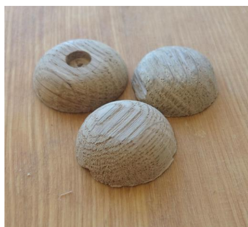
Figur 35. . Utprøving av «klinkehoder» frest ut av eik. Diameter er 30 mm.
