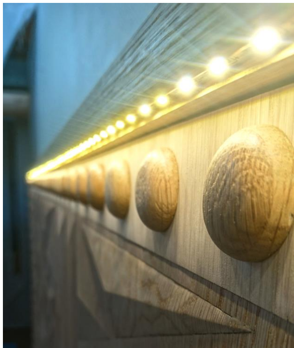
Figur 48. Led- lyslist felt inn i topplisten på hodebrettet.
