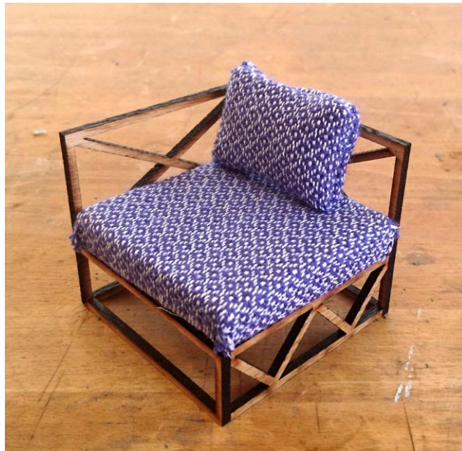
Figur 23. Modell av sofa i størrelse 1:10, skåret ut med laserkutter..
