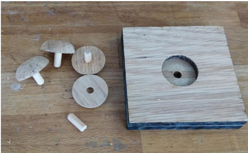
Figur 47. Ferdige "klinkehoder" og mal for boring av hull til sentrumstapp.
