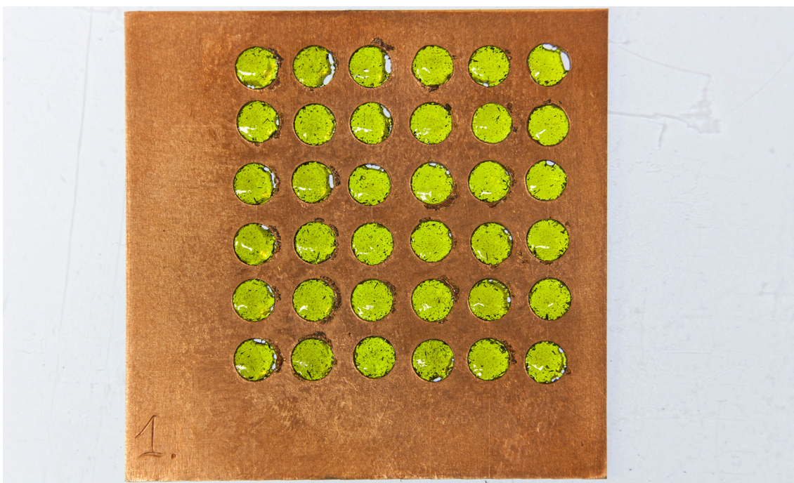
Figur 3-1 Testplate for Klyr-Fire. To kolonner til venstre har ren Klyr-Fire, de to i midten 50/50 blanding, mens de to til høyre er rent vann.
