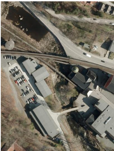
Figur 3. Hamnerdalen er øverst sterkt påvirket av dam ved utløp Farris (1), midtpartiet er dominert av kunstige terskler og vannspeil (2), nedre del av industri og kraftverk (3).
