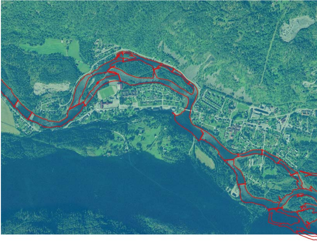
Figur 4. Ortofoto over Tokkeåi fra oppstrøms Huvestadhylen til innløp Bandak med terskler inntegnet (røde tverrstreker)..
