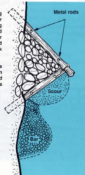
Figur 3. Eksempler på hvordan ulike buner og strømvriderterskler kan øke mangfoldet i strømhastigheter og dyp 3 .
