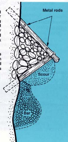
Figur 15. Eksempler på hvordan ulike buner og strømvriderterskler kan øke mangfoldet i strømhastigheter og dyp 2 .
