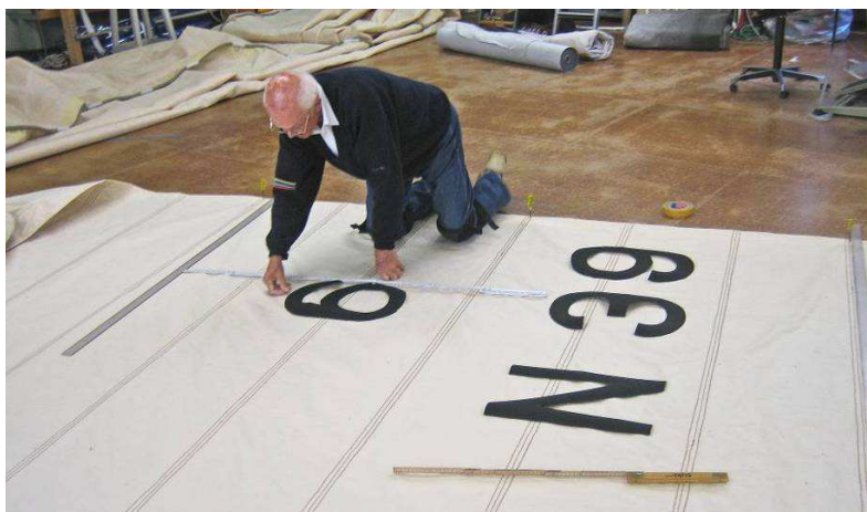
Figur 64: Etter at alle sømmer og forsterkninger er sydd, kan seilets nummer syes fast.
