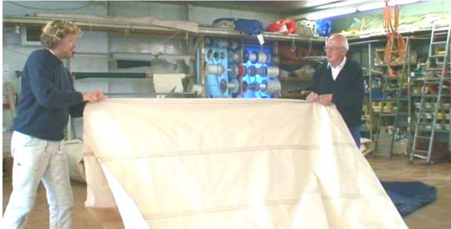
Figur 50: Etter sying blir alle sømmene strukket ut for hånd. Dette er et særegent trinn i arbeidet med vegetabilsk seilduk.
