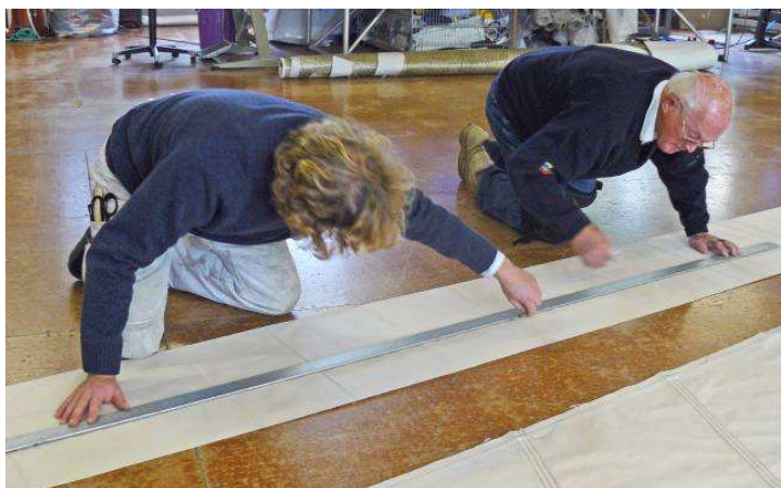
Fig. 56: Tilskjæring av falske søm til for- og underliket.
