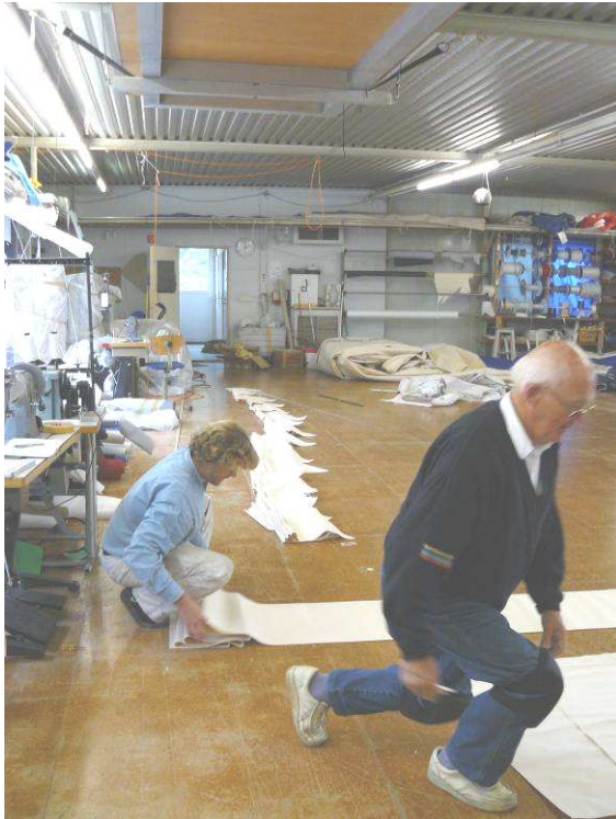
Figur 47 og 48: Dukpanelene legges sammen for sying, venstre bilde. Bildet til høyre viser hvordan de syes sammen.
