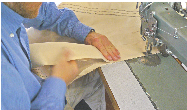
Figur 63: Falske sømmer ble nå sydd på under- og forliket.
