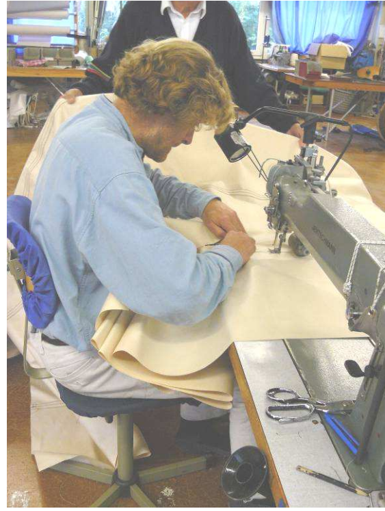
Figur 47 og 48: Dukpanelene legges sammen for sying, venstre bilde. Bildet til høyre viser hvordan de syes sammen.
