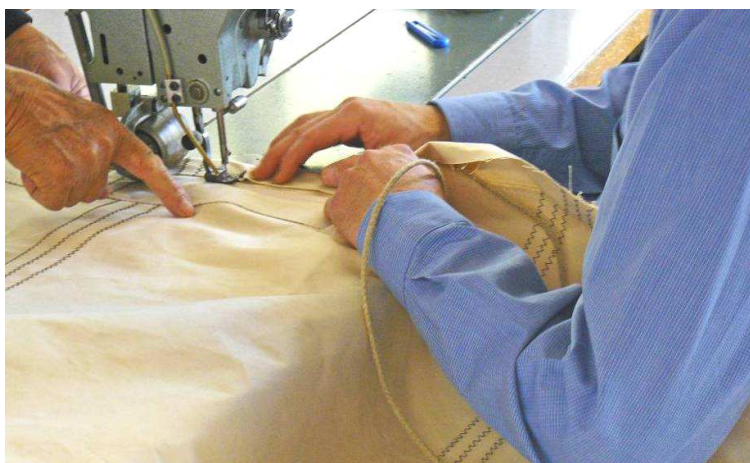
Figur 62: Syng av kantsømmen i akterliket. Legg merke til trimrepet som blir sydd inn i sømmen.
