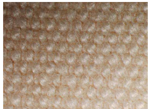
Fig. 30: Mikroskopbilde av egyptisk makko i 18 ganger forstørrelse. Seilet til "Gjøken" er sydd av denne duken.
