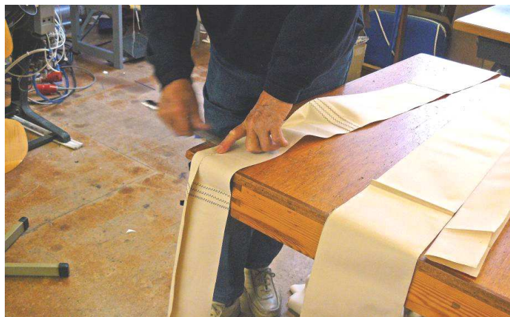
Figur 58: Bretting av kanten i en falsk søm og akterlikforsterkningen.
