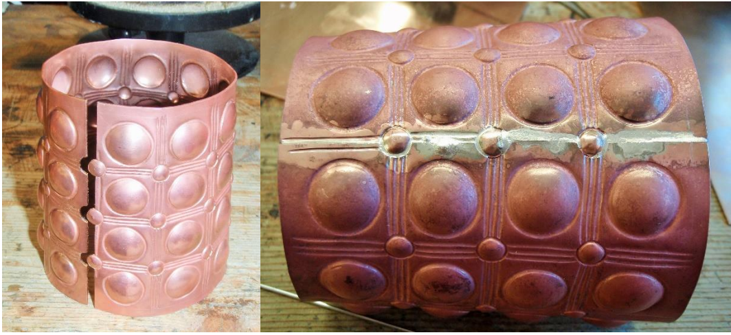
Figur 61 Platen bøyes og loddet sammen. Skjøten måtte files ned og siseleres.
