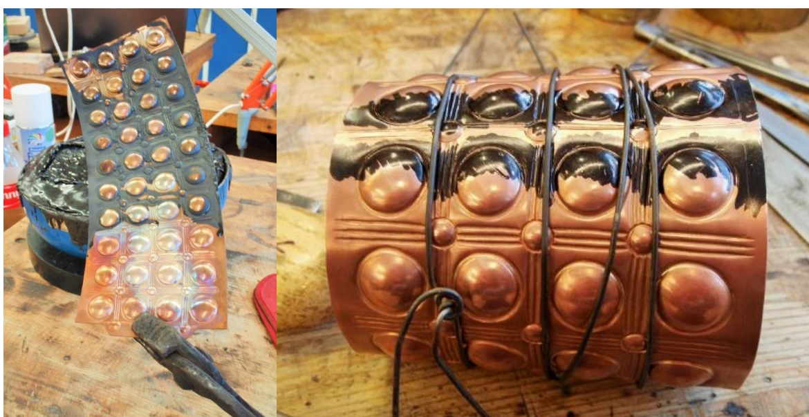
Bronseplaten renses etter siselering, og hovedformen gjøres klar til lodding.
