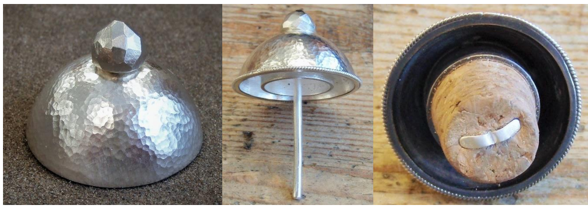
Figur 97 Den stiliserte steinen og tvinnede sølvtråden loddet på sammen med det indre festet til korken, og korken festes.
