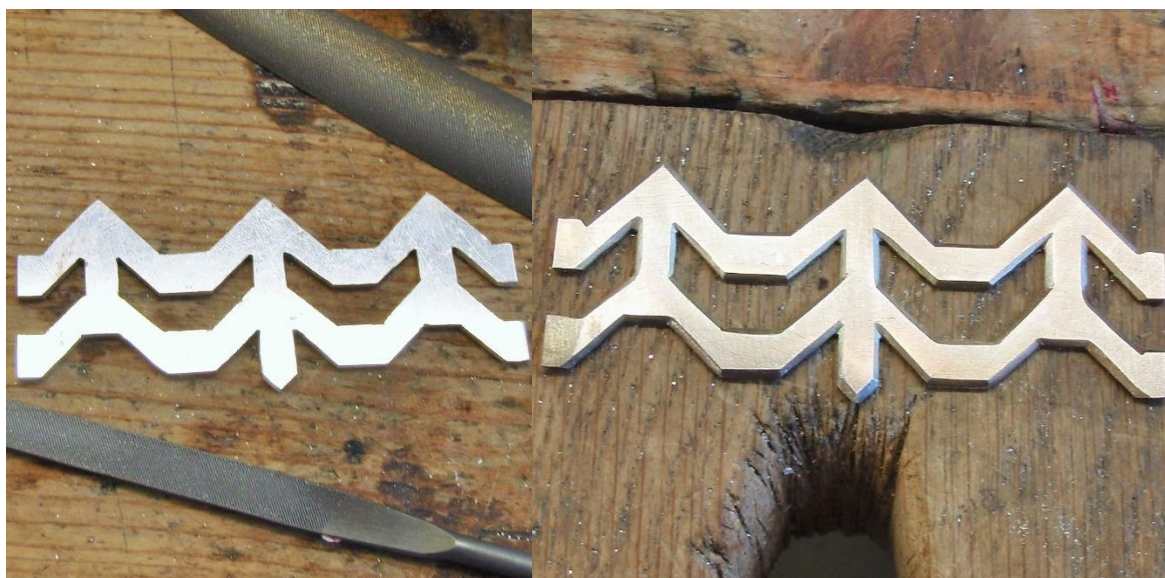
Figur 45 Ringen før og etter at sidene er filt ned.
