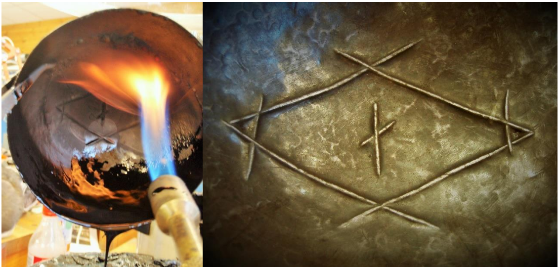
Innsiden av støpeformen under og etter rensing.
