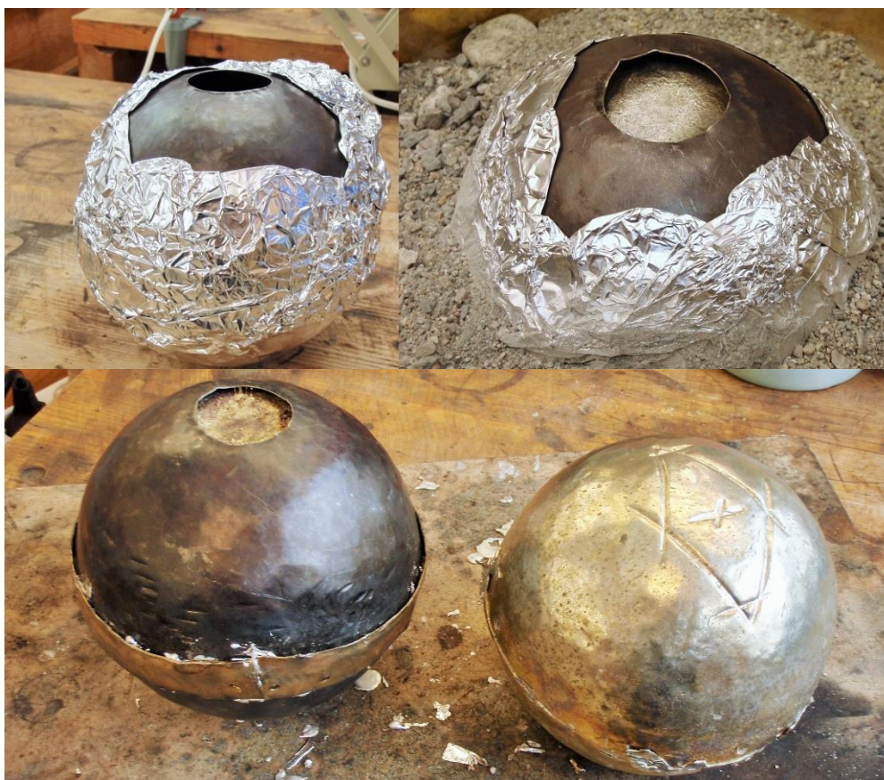
Figur 33 Øynene støpes. Jeg pakket støpeformen inn i aluminiumsfolie, og gravde den halvveis ned i en bøtte med sand for å sikre at tinnnet ikke lekket ut.
