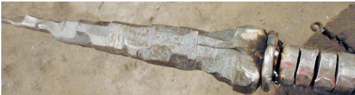
Figur 117 Pommelen er festet, og stålringen i overgangen fra skaftet er sveiset på.
