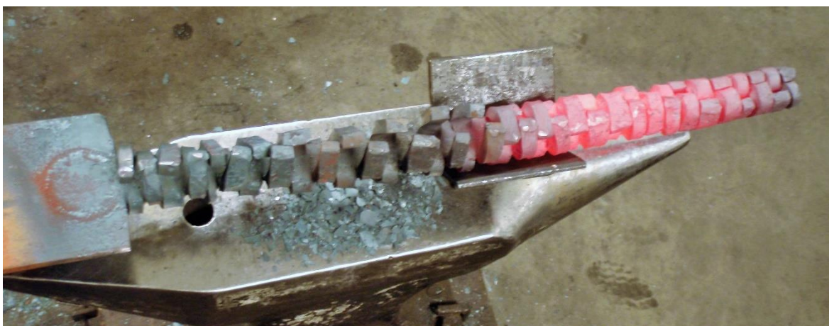
Figur 113 Taggene på kammen hamres helt på plass, og danner et skaft.
