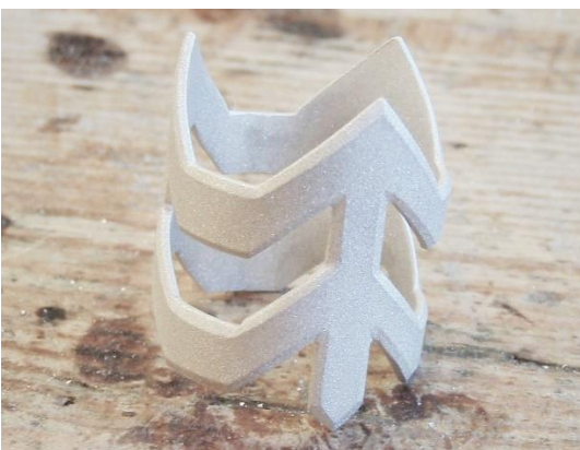
Figur 47 Matt overflate etter sandblåsing.
