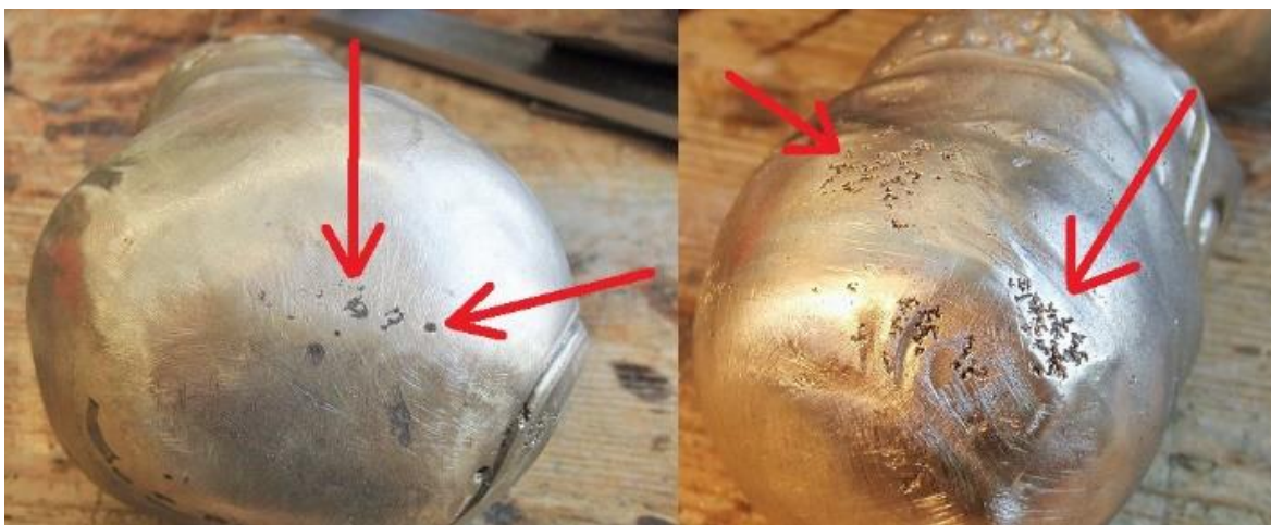
Figur 76 Rester av hull og porøs overflate fra det delvis mislykkede støpet er fremdeles synlige, også etter reparasjonen.
