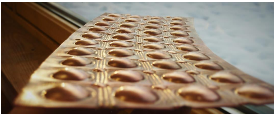
Figur 60 Bronseplaten er ferdig siselert og klar til å bøyes.
