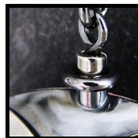
Figur 47: Låsringen rundt låsrøret.
