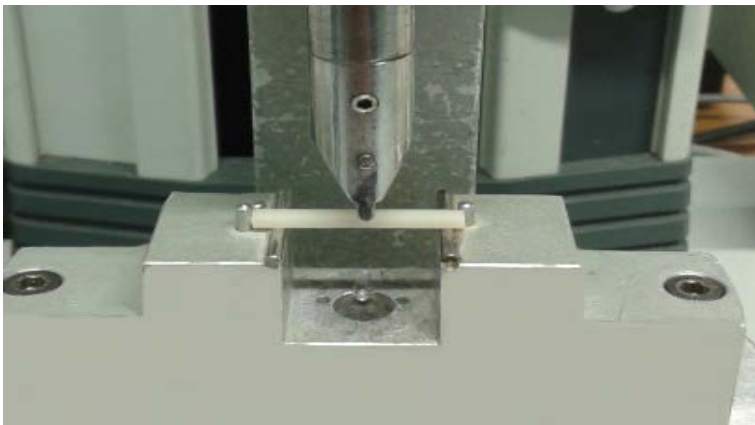
Figur 4-1. Måling av bøyestyrke med Jig som treffer komposittprøve
