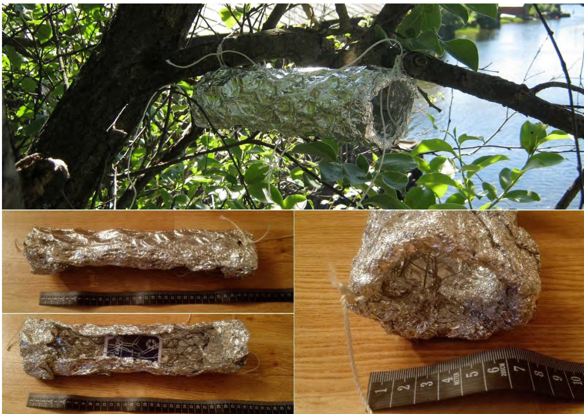
Figur 3: LogTag datalogger med sylinder av hønsenetting og aluminiumsfolie.
