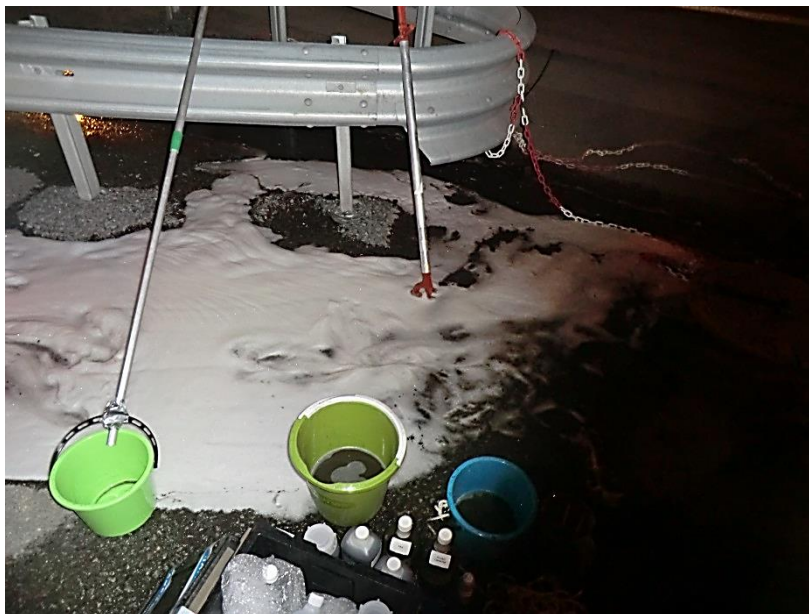
Figur 11. Tunnelvaskevann i vegbanen ved Hanekleivtunnelen (foto: Martin Stamland)
