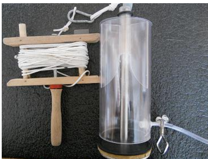
Figur 7. Vannhenter (Esselte, 1 L) med fastmontert termometer. Foto: T. T. Bakke.
