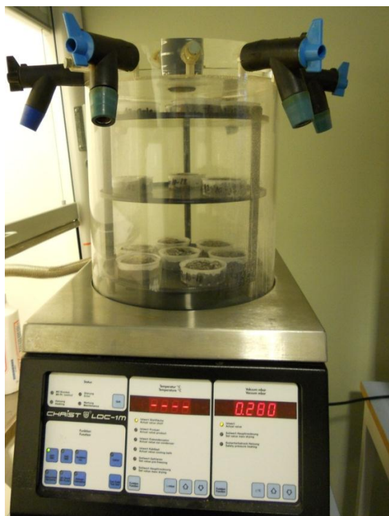
Figur 8. Frysetørrer av typen Christ Alpha 1-4 med sedimentprøver. Foto: T. T. Bakke.
