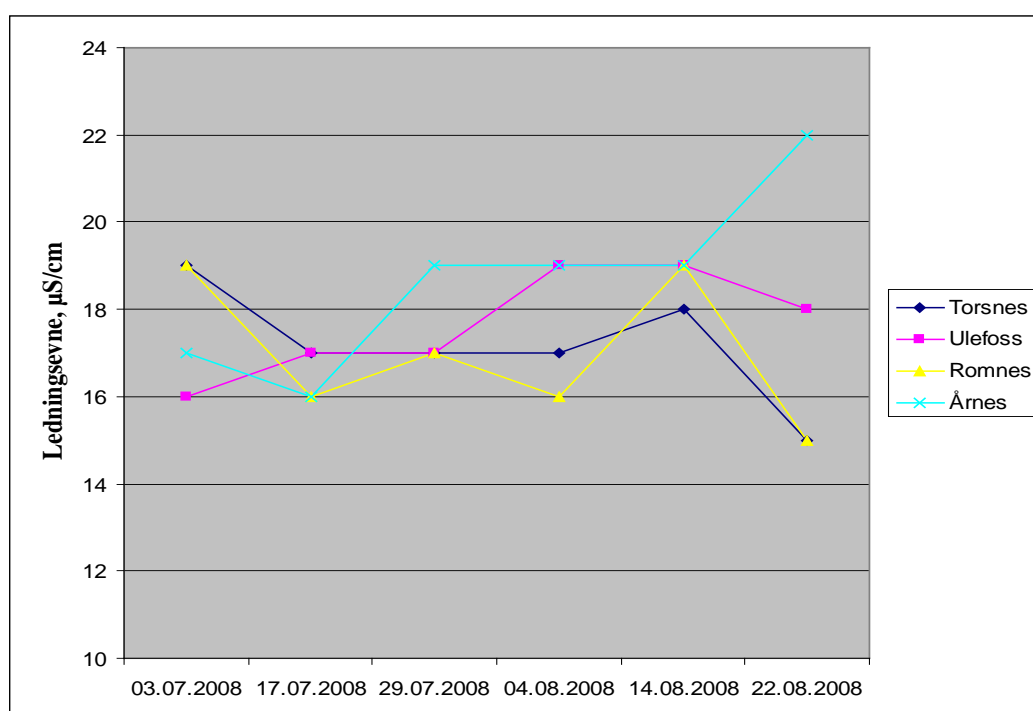
Figur 22. Ledningsevne ved de vestlige prøvestasjonene gjennom prøvetakingsperioden 3.7-22.8.2008
