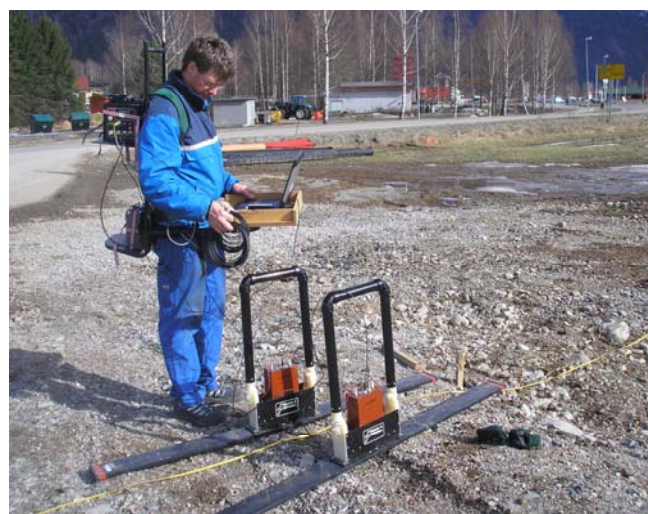
Bilde 3: Georadaroppmåling ved Seljord Næringsbygg. Foto: Dyrud 2007.
