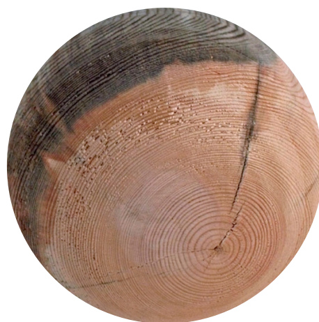
Kule 5 furu vått, heltre, ytterved råtten
