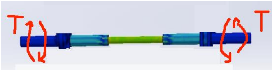
Testplan/Testspesifikasjon Figur 1: Modultesting av sekskantpipe, sekskantstål og prøvestykke
